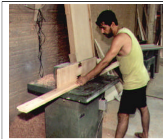
a – Preparo do perfil da tábua na tupia. Fonte: Autor 2001.
