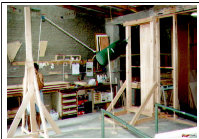
Figura 82: Ensaio de corpo mole das chapas de vedação vertical. Fonte: Autor 2002.
