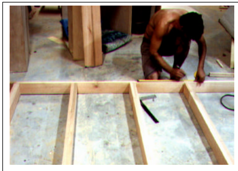
Figura 81: Montagem da armação de madeira para fixação das chapas a serem ensaiadas. Fonte: Autor 2001.
