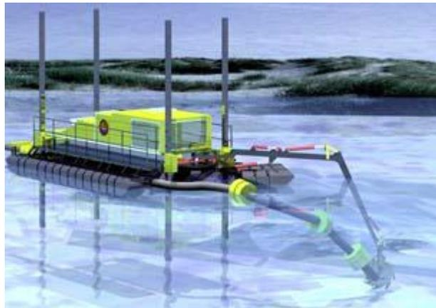
**Figura 3.2.** – Dragagem hidráulica, para pequenas profundidades, com colunas telescópicas de modo a estabelecer o seu posicionamento (www.clearwater.org)
