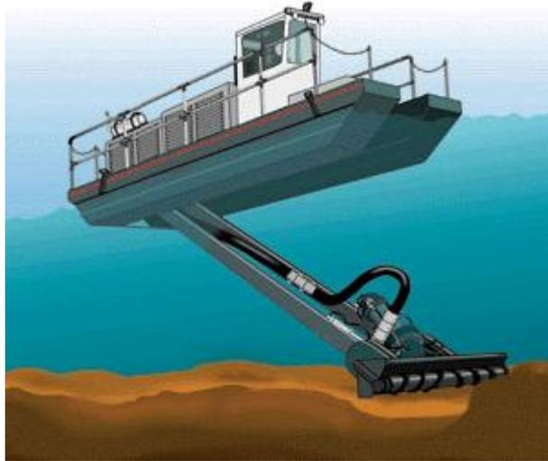
**Figura 3.1.** – Dragagem hidráulica a operar sedimentos (www.merrellbros.com)
