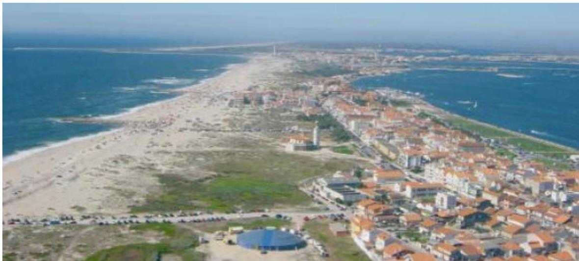
**Figura 2.2.** – Vista aérea sobre a restinga a Sul do Porto de Aveiro. Os sedimentos transportados pela corrente de deriva litoral são parcialmente retidos a Norte, no quebramar Norte do Porto de Aveiro, o que resulta num balanço sedimentar deficitário a Sul. (Foto: Eng. Mota Lopes, DRAOT-CENTRO) – EUROSION
