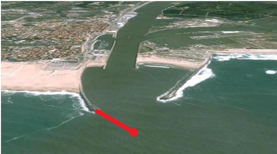
**Figura 1.2.** – Planeamento para a melhoria das condições de acesso e abrigo no Porto da Figueira da Foz (Google Earth, adaptado do IPTM)
