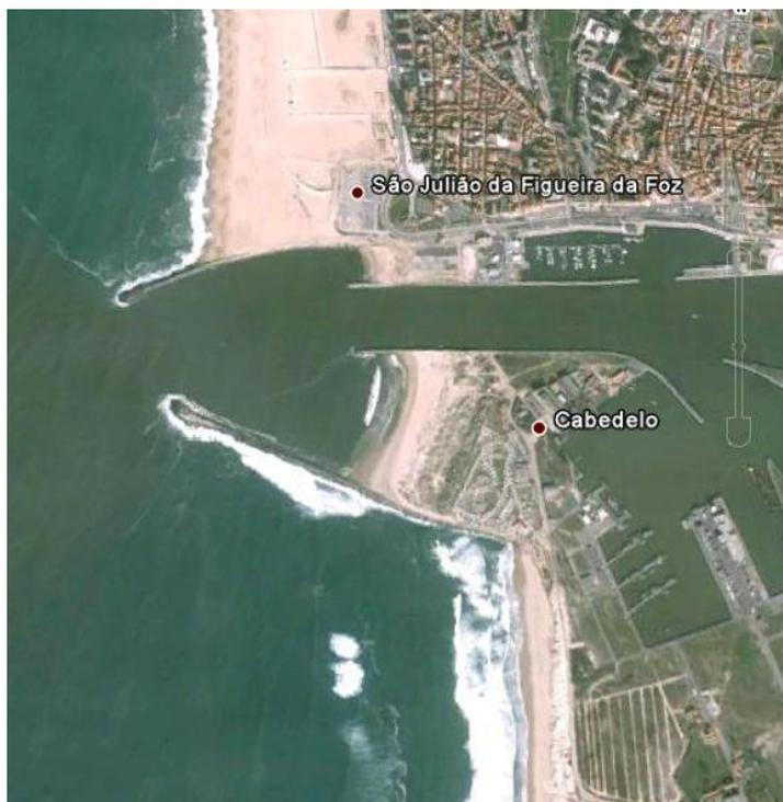
**Figura 2.5.** – Embocadura do rio Mondego na Figueira da Foz, cujo quebramar Norte retém caudal sólido sedimentar engordando a praia adjacente. A praia a Sul da embocadura é extremamente reduzida comparativamente (Google Earth)
