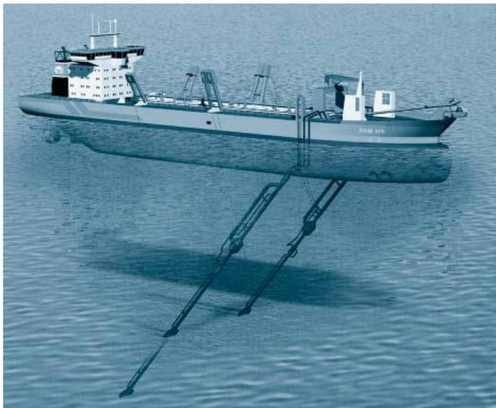
**Figura 3.8.** – Draga de sucção não estacionária – “trailing suction hopper dredge” (www.theartofdredging.com)
