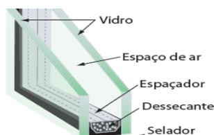
Figura 28: Corte de um vidro duplo
