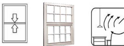
Figura 36: Janela de guilhotina (representação simbólica, janela e forma de ventilação)
