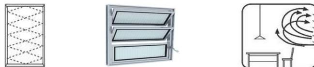
Figura 40: Janelas pivotantes (representação simbólica, janela e forma de ventilação)
