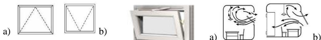
Figura 38: Janela basculante a) e projetante b) (representação simbólica, janela e forma de ventilação)
