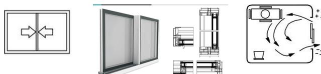
Figura 35: Janela de correr (representação simbólica, janela e forma de ventilação)
