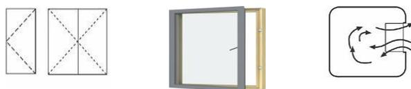
Figura 34: Janela de batente (representação simbólica, janela e forma de ventilação)
