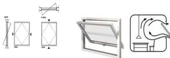
Figura 37: Janela pivotantes (representação simbólica, janela e forma de ventilação)
