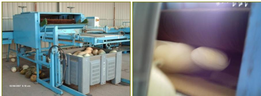
**Figura 20: Volteador de palotes e polidora do melão**
