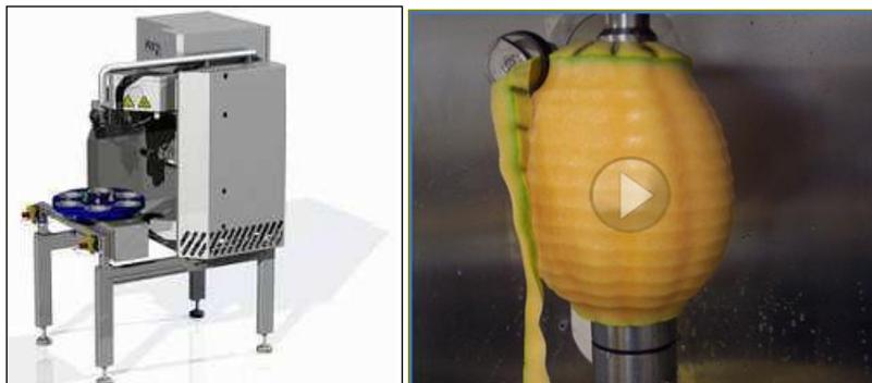
**Figura 23: Descascadora semi-automática de melão**
