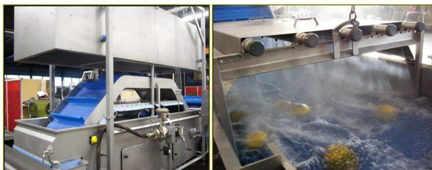
**Figura 22: Lavagem e higienização dos melões seleccionados para o processamento IV Gama**
