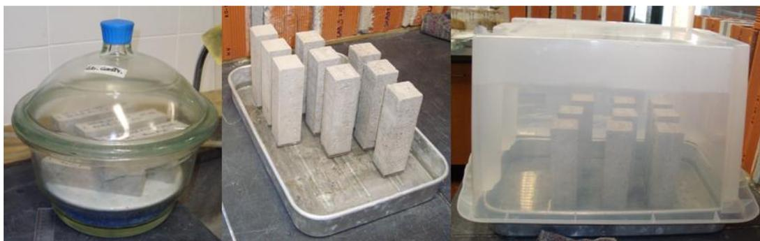
Figura 4.16 - Ensaio de absorção de água por capilaridade
