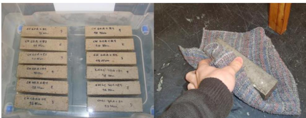
Figura 4.19 - Colocação dos provetes dentro de água e limpeza da água superficial com pano
