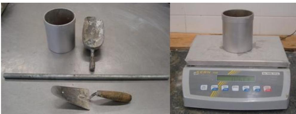
Figura 4.8 - Material utilizado no ensaio e determinação da massa do recipiente
