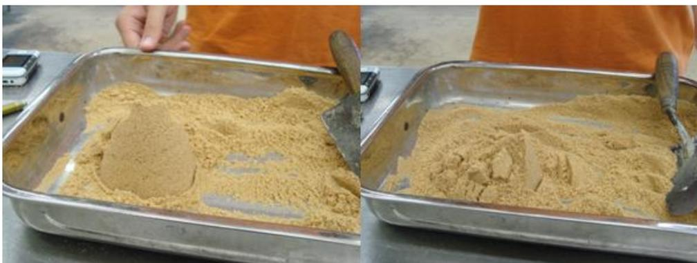
Figura 4.10 – Areia saturada com superfície seca no ensaio de absorção de água
