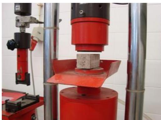
Figura 4.15 - Ensaio de resistência à compressão
