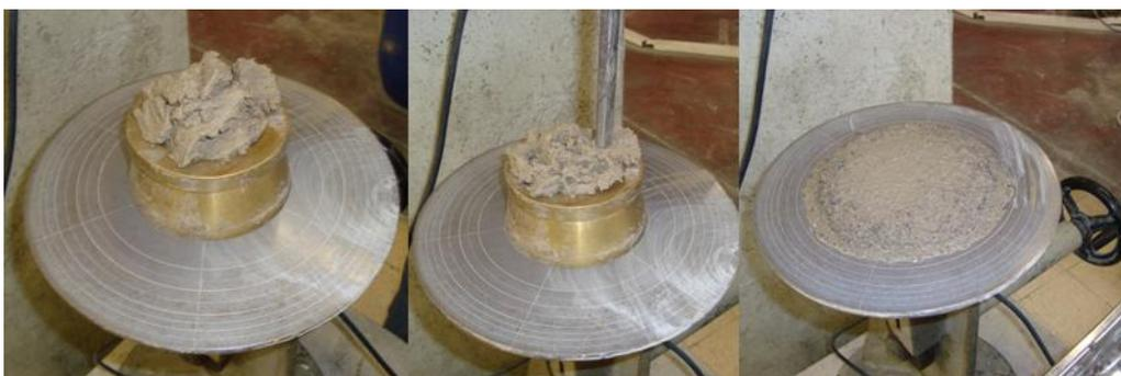
Figura 4.12 - Fase final do ensaio de espalhamento
