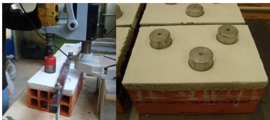
Figura 4.23 - Execução dos entalhes e posicionamento das pastilhas de arrancamento
