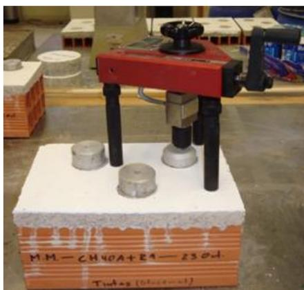
Figura 4.24 - Execução do ensaio de arrancamento
