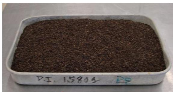
Figura 4.5 - Tabuleiro com regranulado negro de cortiça
