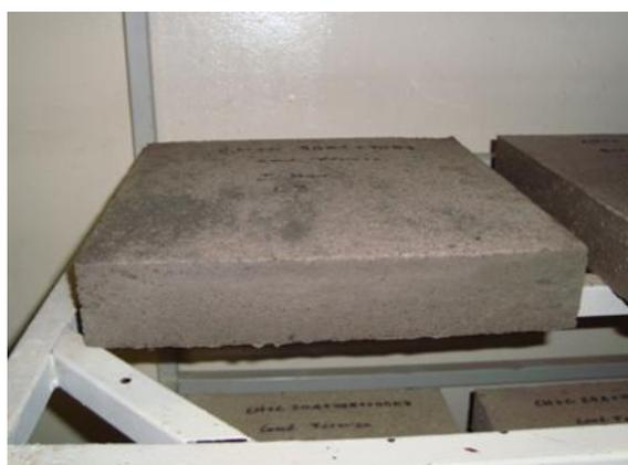
Figura 4.3 - Lajeta na câmara seca
