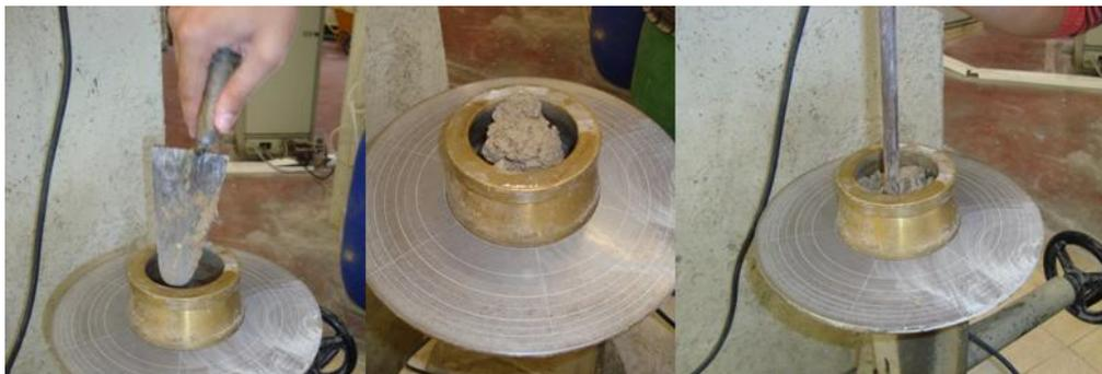
Figura 4.11 - Fase inicial do ensaio de espalhamento
