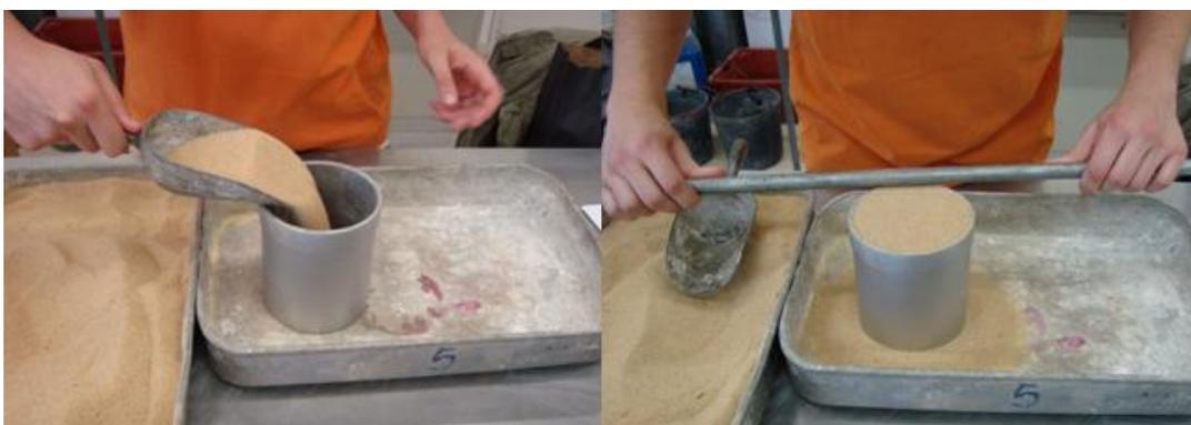
Figura 4.9 - Execução do ensaio de determinação da baridade em agregados
