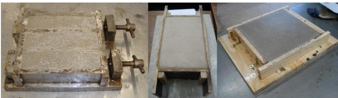
Figura 4.1 - Provetes produzidos antes da desmoldagem
