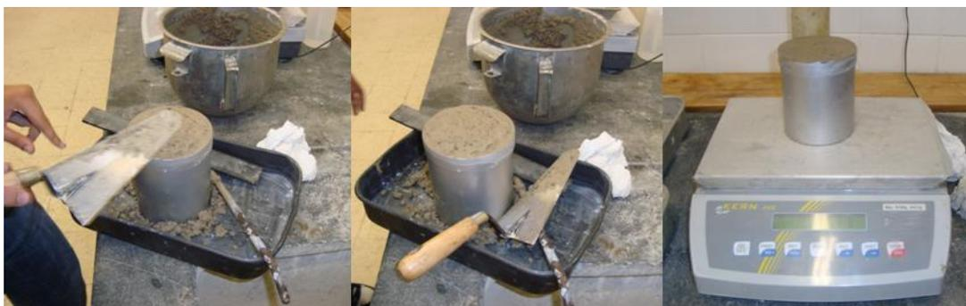
Figura 4.13 - Determinação da massa volúmica aparente da argamassa
