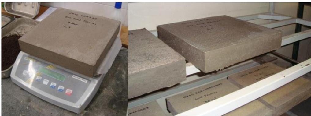
Figura 4.27 - Pesagem após desmoldagem e colocação dos provetes em estufa
