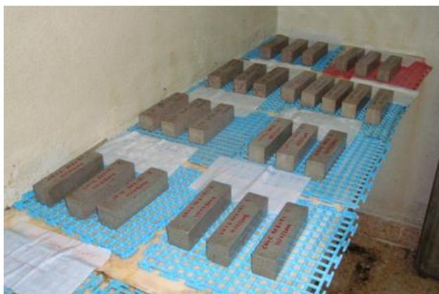
Figura 4.2 - Provetes prismáticos na câmara húmida
