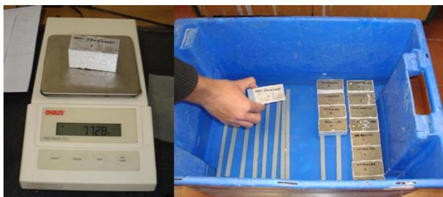
Figura 4.21 - Pesagem dos provetes secos e colocação dos provetes dentro de água
