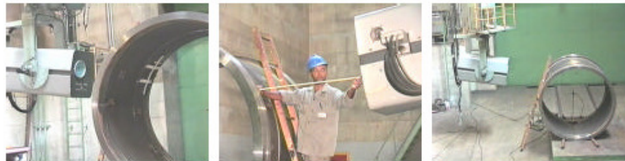
Figura 2. Fotos de um acelerador linear LINAC – Mitsubishi usado para uma radiografia industrial de peças com espessura de 20 a 300 mm de aço. (Andreucci, 2008)
