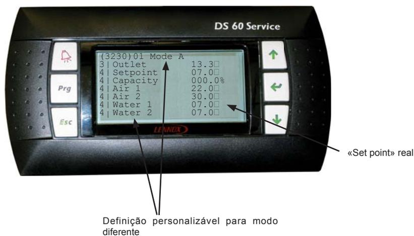
Os submenus contêm 2 tipos de dados: os dados só de leitura (com uma sonda de temperatura, por exemplo) e os “set points” de leitura/escrita (como o “set point” da água de arrefecimento, por exemplo). Os dados são identificados pelo símbolo de um cursor “>” ao passo que os “set points” são identificados pelo símbolo “>>”.
