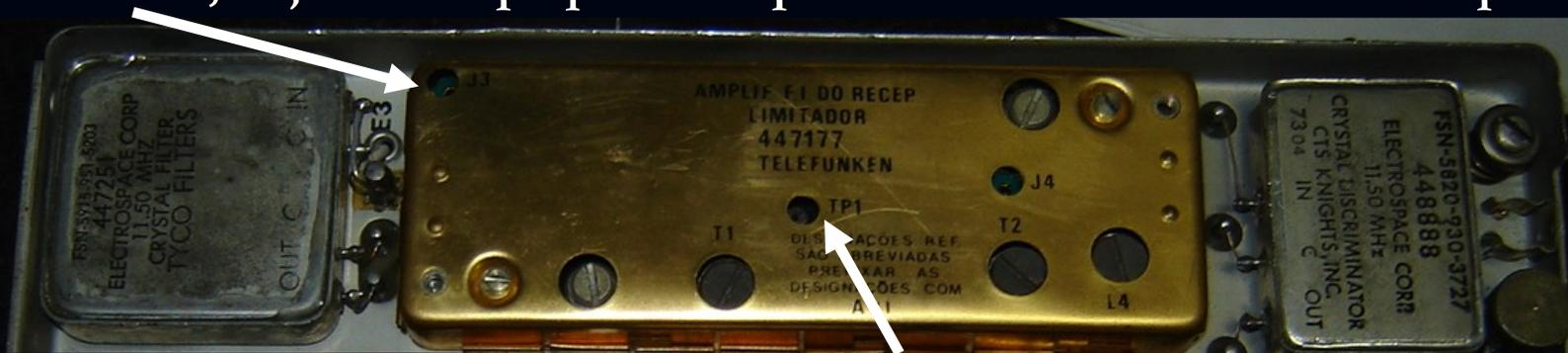
■ TP1 de A21 – Permite verificar o ajuste do transformador T1. A medida realizada sobre este ponto deve ser feita com cuidado para que o coletor do transistor Q4, sobre o qual se realiza o teste, não seja curto circuitado com a tampa do módulo.
