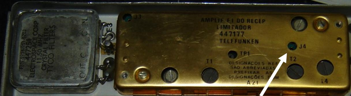
■ J4 de A21 – Permite verificar o ajuste do transformador T2. A medida realizada neste ponto não permite a determinação do correto funcionamento do módulo.
