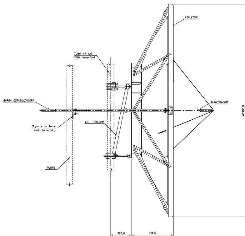
FIGURA 01 – Principais componentes da antena
