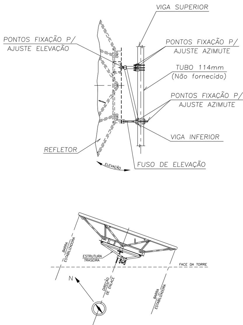
FIGURA 15 – Pré-Alinhamento da Antena em Azimute
