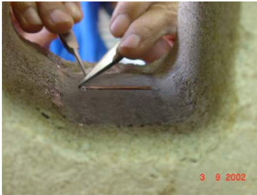
Figura 24 - Posicionamento do extensômetro.
