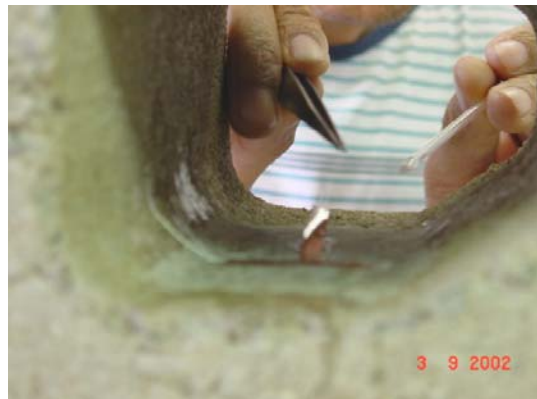
Figura 27 - Colagem do extensômetro longitudinal.
