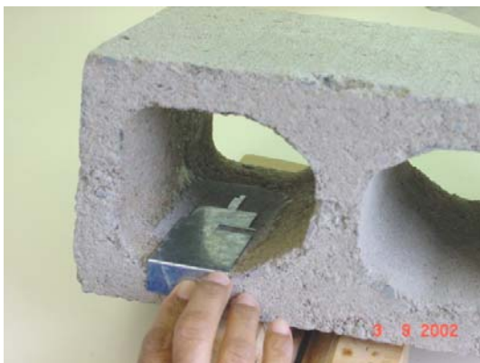
Figura 22 - Gabarito para marcação dos extensômetros.
