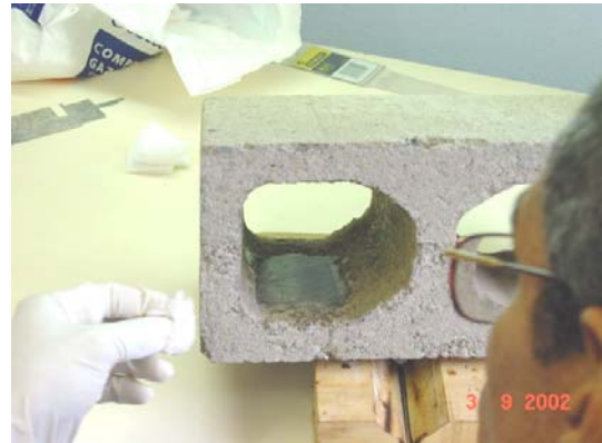
Figura 21 - Procedimento de limpeza e desengraxe do local de colagem
