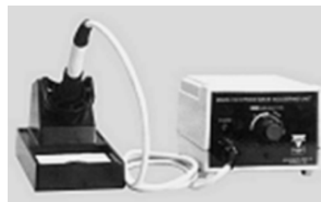
Figura 33 - Estação de solda.
