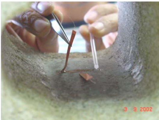
Figura 26 - Colagem do extensômetro transversal.
