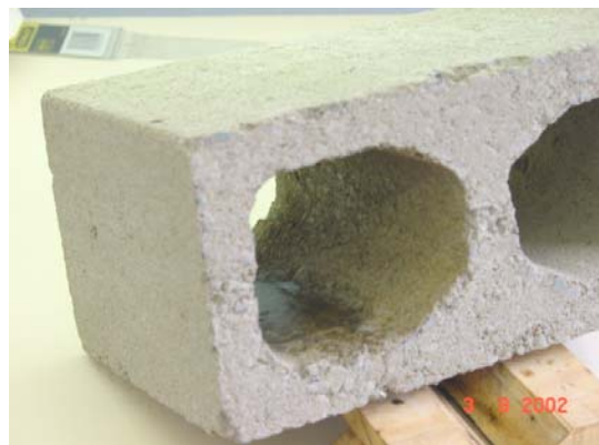
Figura 23 - Local de colagem do extensômetro limpo e desengraxado.
