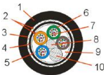
Figura 30 – Cabo de fibras ópticas para conduta
