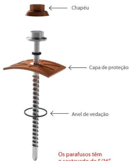
Para melhor acabamento na obra, a Araforros disponibiliza os **Kits Originais de Vedação e Fixação Top Line**. O kit é composto por capas de proteção para a telha, anéis de vedação contra água e parafusos autobrochantes, que além de permitirem uma fixação segura, oferecem estanqueidade total ao telhado.
