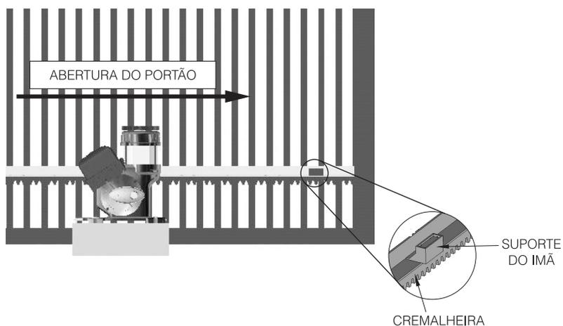
**3º Passo:** Acione o motor e observe se os REED's estão desligando corretamente. Caso haja necessidade, inverta o conector da placa. Depois de fixados os suportes dos ímãs, faça os ajustes finais, deslocando-os para a direita ou para a esquerda, conforme o ajuste desejado.
