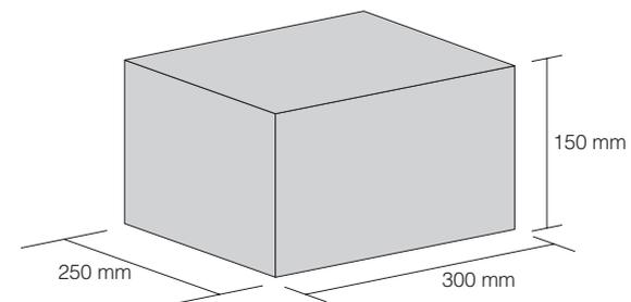
**2º Passo:** As dimensões da base deverão ser apropriadas para as dimensões do automatizador. A base de concreto deverá ficar a uma distância de aproximadamente 20 mm da face da folha do portão.
