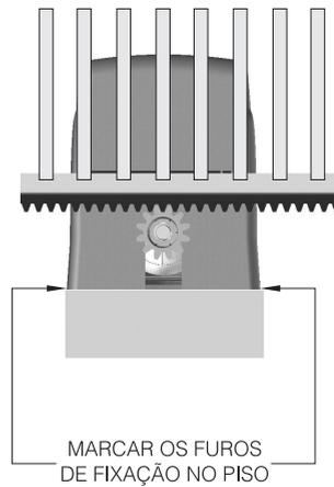
**5º Passo:** Faça a furação para a fixação, posicionando o automatizador alinhado ao portão. Antes de apertar os parafusos S 1/4" x 2 1/2", movimente o portão, verificando se o mesmo não encosta no automatizador no decorrer de seu percurso. Caso isso ocorra, recue o automatizador.
