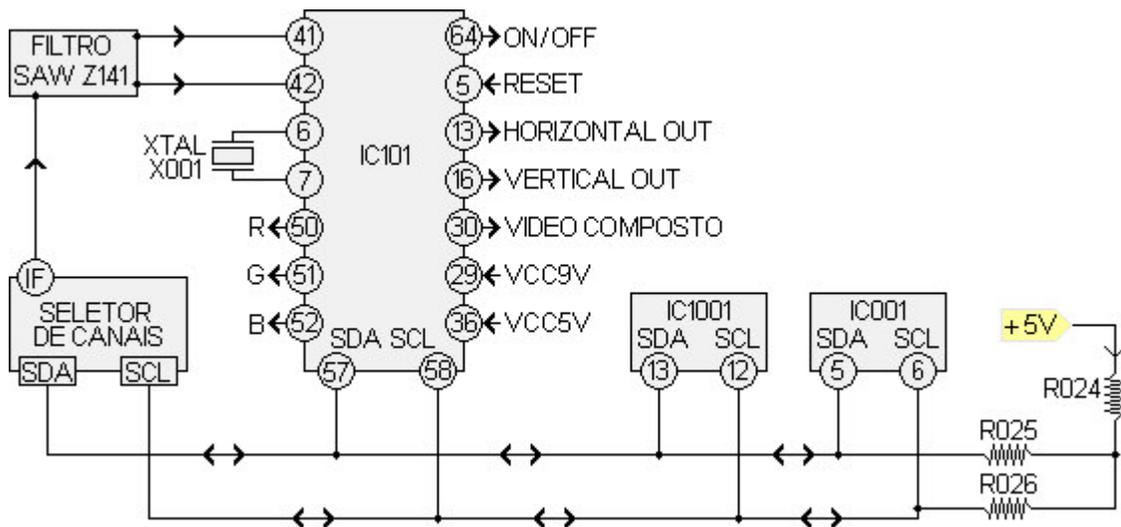
As medidas de tensões mencionadas nas tabelas a seguir são dos pinos dos principais integrados e foram coletas com multímetro digital, o produto ligado em rede de 127V e sintonizado no canal 12 com gerador de barras coloridas.
