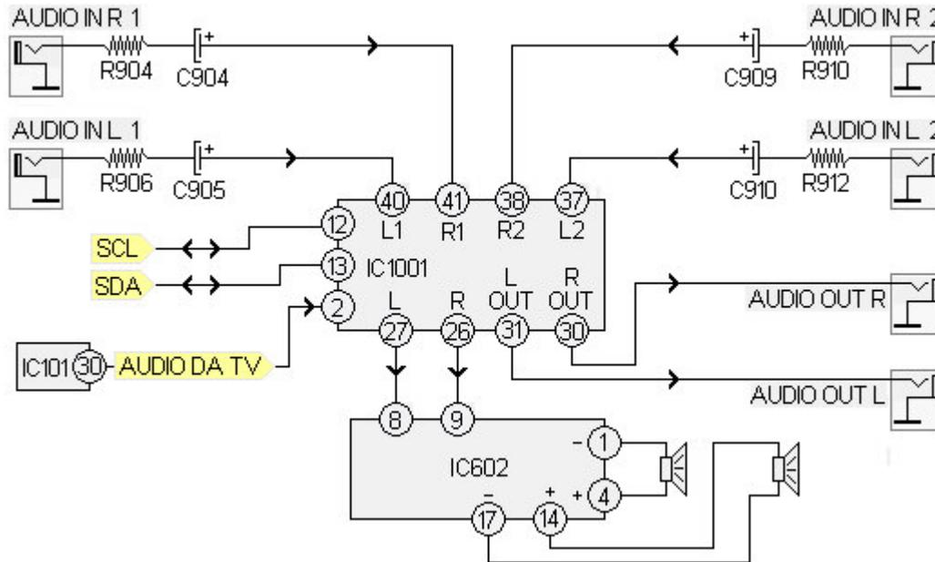
A figura a seguir mostra de forma simplificada e apenas ilustrativa, os principais componentes dos integrados que atuam com as linhas de dados SDA e SCL e alguns principais pinos do microprocessador IC101.
