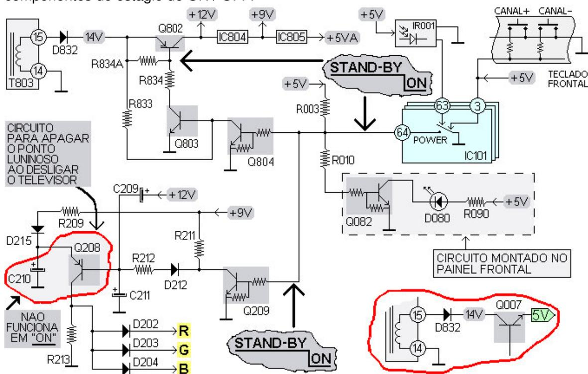
A figura a seguir mostra de forma simplificada e apenas ilustrativa os principais componentes do estágio da fonte de alimentação principal e o destino da cada tensão. Lembrando que há componentes que alteram estas tensões desde que são geradas até os destinos finais.
