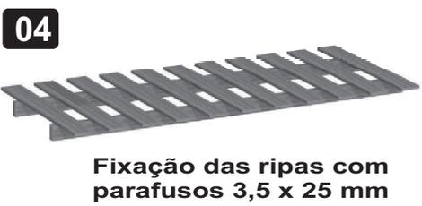
**Fixação das ripas com parafusos 3,5 x 25 mm**
