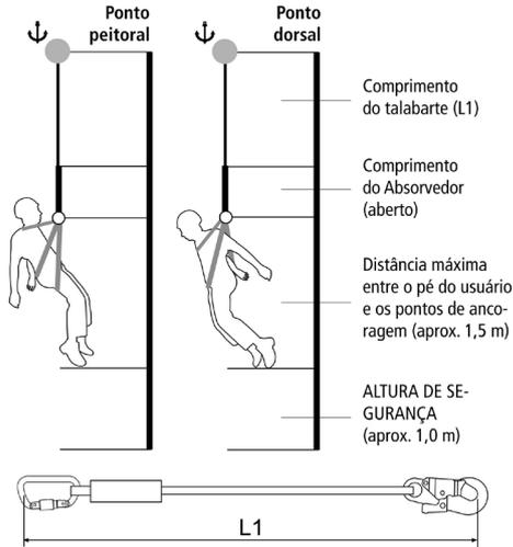
A medida de L1 deve compreender a extremidade interna de um conector ao outro do talabarte (com absorvedor fechado), conforme figura abaixo.
