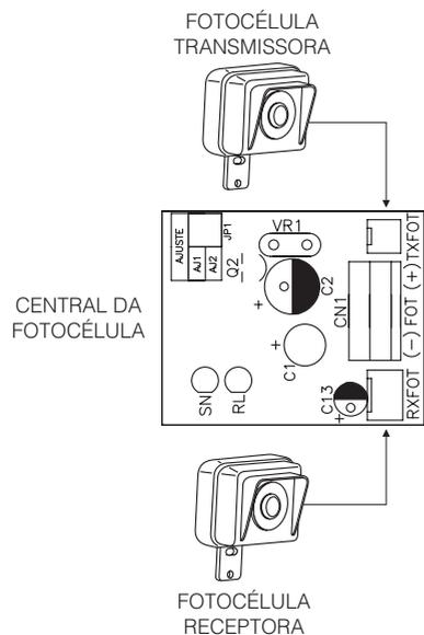
**1º Passo:** Fixe as unidades transmissora e receptora alinhadas entre si a uma de 30 cm e de modo que a tampa por onde saem os fios fique voltada para baixo, a fim de evitar possível entrada de água;
