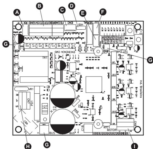
**A)** Ao conector "RX", conecte um receptor avulso (opcional) para acionar o equipamento com controle remoto.
