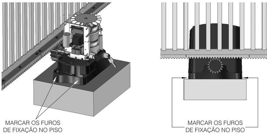
**5º Passo:** Faça a furação para a fixação, posicionando o automatizador alinhado ao portão. Antes de apertar os parafusos S 1/4" x 2 1/2", movimente o portão, verificando se o mesmo não encosta no automatizador no decorrer de seu percurso. Caso isso ocorra, recue o automatizador.
