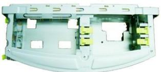
Encaixe o suporte metálico com o CD/DVD e HDD no local indicado, seguindo o sentido da imagem para instalação. Trave o suporte no gabinete e ligue os cabos SATA e de alimentação do HDD e CD/DVD.
