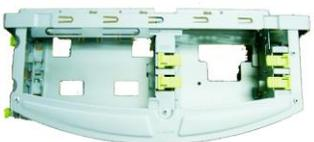
Desconecte os cabos SATA e de alimentação do CD/DVD e do HDD, abra as travas do suporte de ambos os lados, incline o suporte para desencaixá-lo e retire-o puxando-o para cima.
