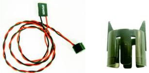
Passo o cabo do buzzer dentro do suporte e prenda-o. Localize o local de instalação do buzzer no gabinete, instale-o no sentido indicado e verifique se as travas estão presas ao gabinete.
