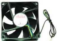
Desconecte o conector do ventilador, retire o cabo da cinta plástica, retire o ventilador e retire o suporte do ventilador.
