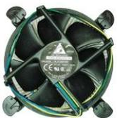
Desconecte o cabo do cooler da placa-mãe, gire as travas do cooler no sentido anti-horário para soltá-lo e remova-o.
