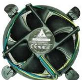
Amarre o cabo do conector do cooler conforme a figura, insira o cooler na PLM encaixando-o em cima do processador, prenda o cooler na PLM e ligue o conector na placa-mãe.
