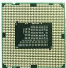
Remova a tampa plástica protetora, solte a trava e abra o escudo do soquete, coloque o processador e feche a trava.
