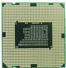
Solte a trava de segurança do processador pressionando-a para baixo e em seguida para o lado, abra a aba da tampa conforme indicação e retire o processador. Feche a tampa e a trava, e encaixe a proteção plástica sobre o soquete, para não danificar os pinos.
