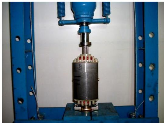
**3 -** Com auxílio de um pito 23 mm prensar o novo rolamento no eixo.
