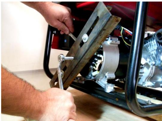
**12 -** Com o auxílio de um sacador, efetuar a retirada do estator.
