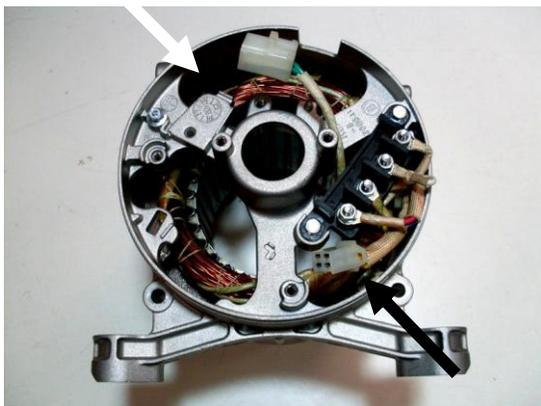
**13 -** Para remover a base do alternador do estator, soltar os parafusos de fixação.
