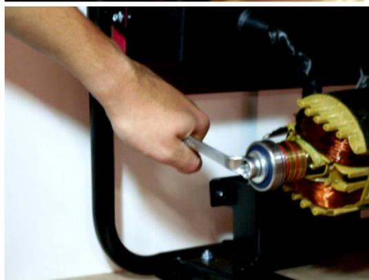
**15 -** Com auxílio de uma chave travar a porca do volante e retirar o parafuso do induzido.
