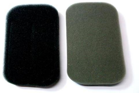
**2 -** Retirar as espumas e lavá-las com água e sabão neutro; deixar secar ao sol. Depois de seca, umedecer com óleo de motor; apertar bem para retirar o excesso antes de recolocá-las.
