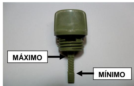
**3 -** Após o abastecimento, verificar o nível de óleo. O nível correto de óleo é na marca "máximo" da vareta. O motor deve trabalhar com o nível de óleo conforme as marcas desenhadas na vareta, ou seja, entre o mínimo e o máximo
