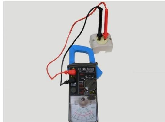
4 - Conectar as pontas de prova do multímetro aos terminais ou fios do componente a ser medido.
