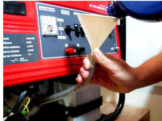
1 - Retirar a vareta de nível de óleo. Com o auxílio de um funil e uma mangueira, abastecer o cárter com óleo para motores a gasolina.
