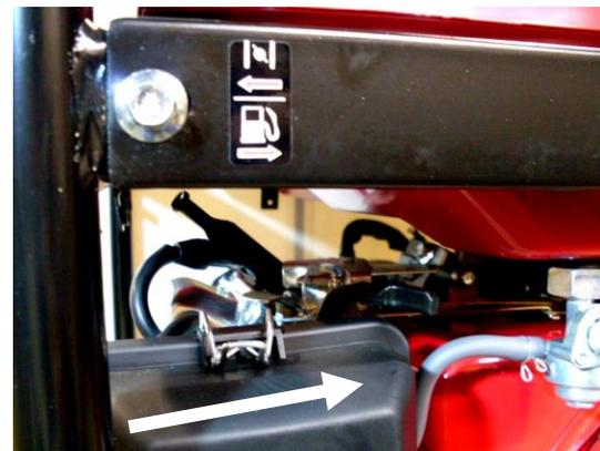
**5 -** Após o funcionamento do motor, retorne a haste do afogador para a posição inicial.
