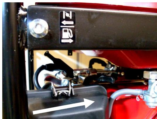
**5** - Após o funcionamento do motor, retorne a haste do afogador para a posição inicial.
