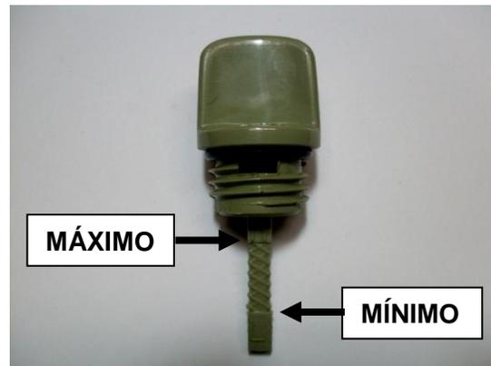
2 - Após o abastecimento, verificar o nível de óleo. O nível correto de óleo é na marca “máximo” da vareta. O motor deve trabalhar com o nível de óleo conforme as marcas desenhadas na vareta, ou seja, entre o mínimo e o máximo.
