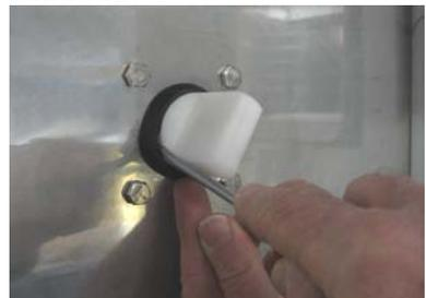
*Corte ou tire a velha vedação do eixo e descarte-a.*
