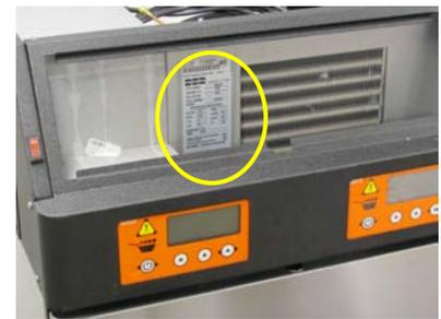
O Número de Série da Unidade F3D3 está situado no adesivo de dados colado à esquerda da entrada da serpentina/ar do condensador superior frontal. Levante e retire o painel de acesso engradado e retire o filtro.
