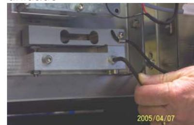
Retire os dois parafusos de montagem de Braçadeira do Elemento de Carga.
