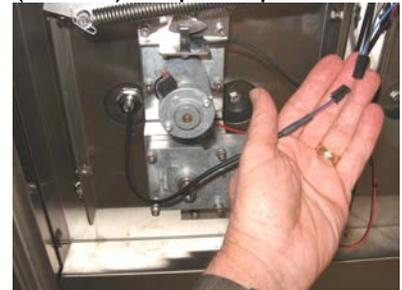
Desconecte os condutores do sensor da Fiação Elétrica Principal.
