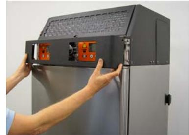
Retire os quatro parafusos de montagem lateral e puxe o engaste frontal para fora.
