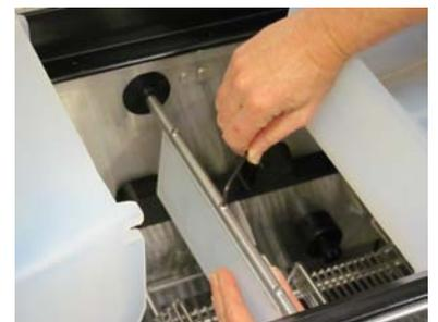
Levantar o depósito de borracha, abrir as portas de carga e retirar os três parafusos de montagem de cada um.
