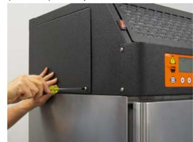
Retire os dois parafusos do lado esquerdo do painel de acesso elétrico.
