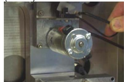
Retire primeiro os quatro parafusos de montagem do motor superior.
