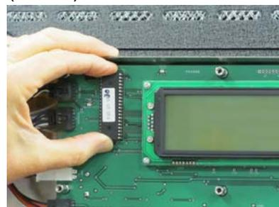
Quando instale o novo chip, primeiro alinhe a fenda do chip com a fenda do apoio e depois alinhe os pinos do chip com os orifícios do apoio. Pressione suavemente para encaixar.
