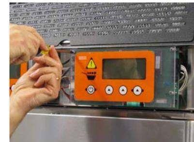
Retire os quatro parafusos de montagem do painel de controle.
