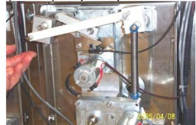
Retire o clipe de retenção da mola do pino de bloqueio de rotação da porta do lado esquerdo e depois alivie a tensão da mola.
