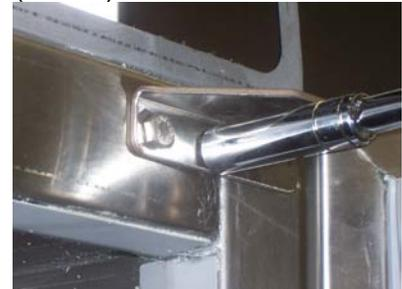
Retire os parafusos de montagem do suporte de montagem da dobradiça superior e eleve a porta para fora do pino da dobradiça inferior.
