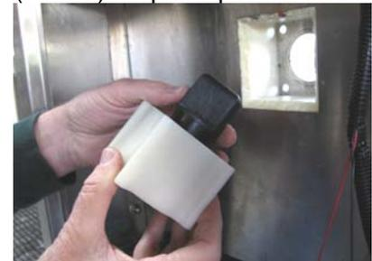
Insira o novo eixo do motor/rotor no bloqueio do rotor perfilado.
