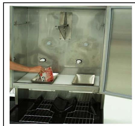
**DICA:** Se o peso de calibração de 1,5 lb/680g não estiver disponível, use uma caixa de hamburguers congelados (680 g). Limpe a Caçamba de Produto depois da calibração.
