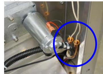
Use o velho aquecedor para puxar o novo aquecedor através do circuito de cobre.
