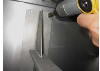
Usando uma chave de porca de 8 mm (5/16"), solte os quatro parafusos da Braçadeira de Suporte do Depósito. Movimento para cima ou para baixo da braçadeira de suporte da direita ou da esquerda, caso seja necessário.
