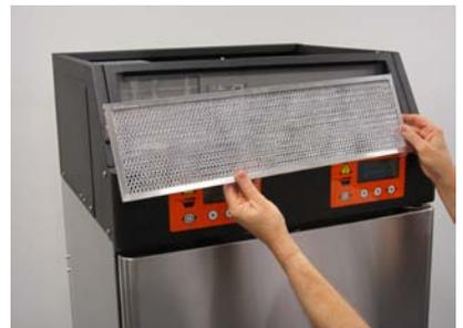
Inspeção o filtro da serpentina do condensador. Levante e retire o filtro. Não há parafusos. Se está sujo, lave-o na pia e espere que seque antes de recolocá-lo.
