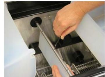
Gire a porta para baixo e retire os três parafusos de montagem usando uma chave de fenda hexagonal de 1/8" (3mm).
