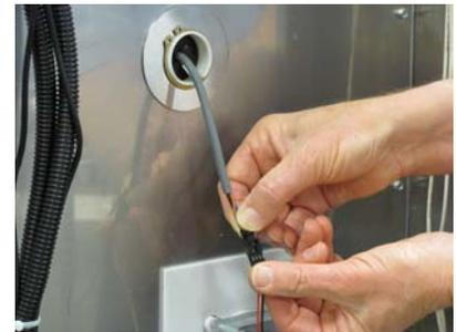
Desconecte o Sensor de Produto Baixo do terminal da fiação.
