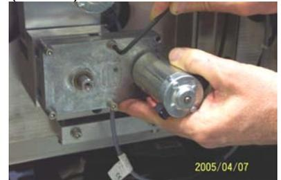
Insira e ajuste os quatro parafusos de montagem do motor (levantamento da porta).
