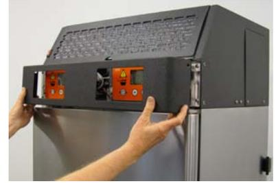
Retire os quatro parafusos do engaste/tampa do painel de controle frontal e puxe o engaste/tampa para fora.
