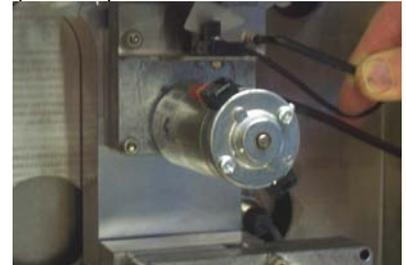
Use uma chave de fenda hexagonal de 4mm (5/32"), para retirar e ajustar os parafusos de montagem.
