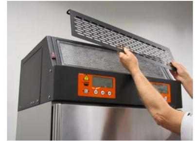
Para inspecionar a serpentina do condensador e o filtro da serpentina, levante e retire o painel de acesso frontal com ventilação.
