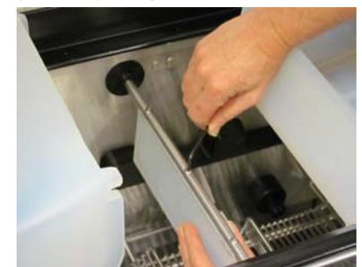
Levante o depósito de borracha, abra as portas de carga e retire os três parafusos de montagem de cada um.
