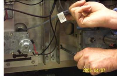
*Retire os quatro parafusos de montagem do Conjunto de Automação.*
