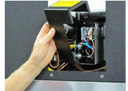
Retire o parafuso e deslize a cobertura da caixa do relé para cima e para fora.
