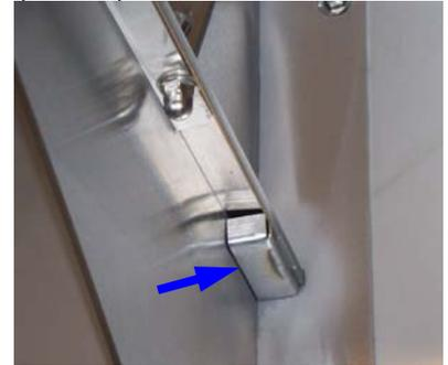
O bulbo sensor desliza para dentro de uma caixa de proteção montada na Braçadeira de Suporte do Centro do Depósito dentro do compartimento do freezer.
