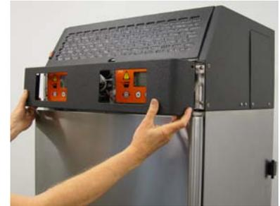
Retire os quatro parafusos do engaste/tampa do painel de controle frontal e puxe para fora.
