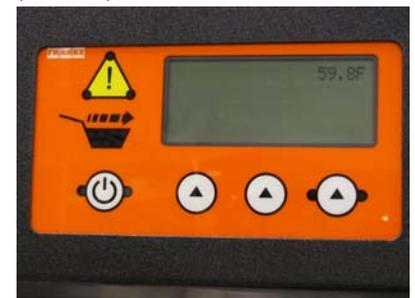
Quando o interruptor principal de energia está em ON (ligado) a temperatura atual do compartimento aparece na parte superior direita do Visor de Pista Principal (normalmente à esquerda).
