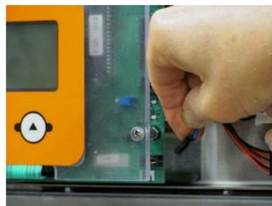
*Desconecte o conector TEMP PROBE do terminal do painel de controle esquerdo, puxe através do painel direito e conecte ao terminal TEMP PROBE.*
