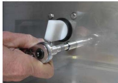
*Retire e descarte os quatro parafusos de montagem do bloqueio.*
