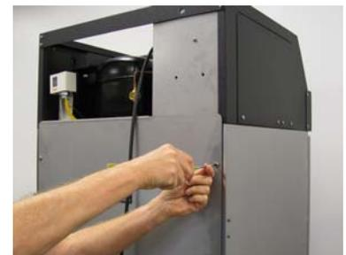
Retire os parafusos e levante e tire o painel de acesso de serviço traseiro.
