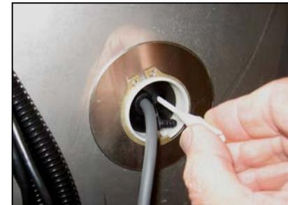
Após a remoção do pequeno plugue de plástico, use a chave de fenda de plástico de 1/16" fornecida para ajustar a sensibilidade do sensor.
