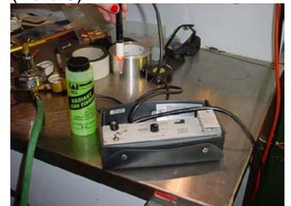
Se a pressão do sistema é demasiado baixa ou as fugas são difíceis de localizar, pressurize o sistema com 150 PSIG (10,5 Bar) de nitrogênio e use um detector eletrônico de fuga ou uma solução de água e sabão.
