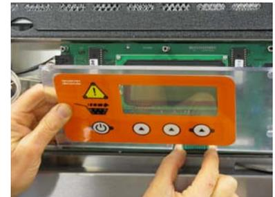
Desconecte o cabo plano do painel digital do painel de controle.
