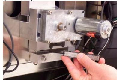
*Após a substituição do Conjunto de Elemento de Carga, verifique a calibração do elemento de carga usando um calibrador de 0,020 (0,50 mm) ou um medidor de distância.*
