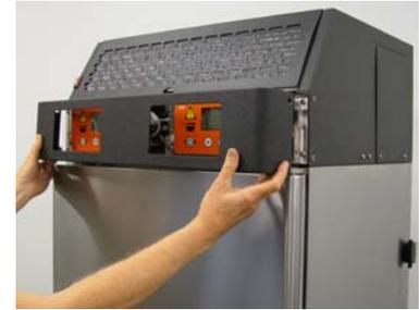
Retire os quatro parafusos do engaste/tampa do painel de controle frontal.
