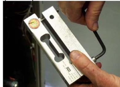
*Separe o Elemento de Carga da braçadeira de montagem retirando o parafuso do lado direito do conjunto.*
