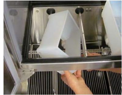
*Para retirar, torça o depósito para limpar o canal da base frontal do freezer e puxe o eixo da porta.*
