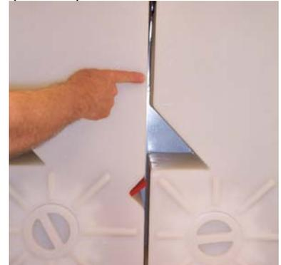
Para verificar o alinhamento da Braçadeira do Depósito, assegure-se de os Depósitos possam ser instalados facilmente e que estejam paralelos e com aproximadamente 1/2" (13 mm) entre os Depósitos.
