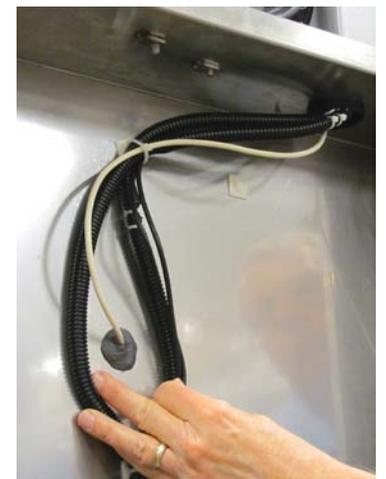
Na parte traseira da unidade, localize o orifício por onde o sensor entra no compartimento de refrigeração e retire a pasta. Puxe o sensor para fora da caixa de proteção. Libere o cabo do sensor do feixe da fiação.
