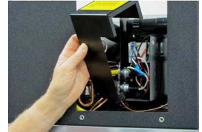
Retire o parafuso e deslize a cobertura da caixa do relé para cima e para fora.
