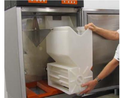
Um rotor com alça está montado dentro de cada Depósito para mover suavemente as fritas para a área de distribuição.
