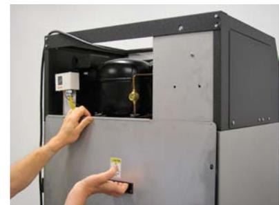
Depois de retirar os parafusos Phillips, levante o painel para retirá-lo do suporte.
