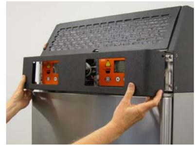
Retire os quatro parafusos que prendem o engaste dos controles frontais.
