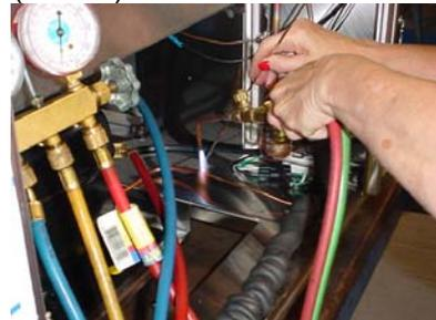
*Quando vede o sistema, use uma carga contínua de Nitrogênio para manter os contaminantes fora.*
