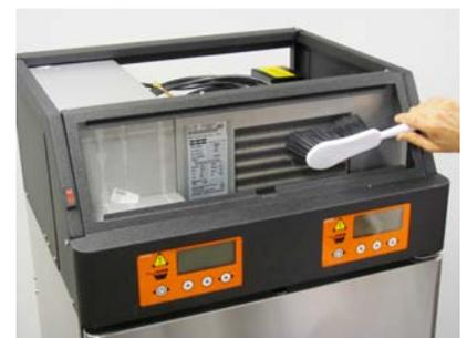
Use uma escova macia ou um aspirador portátil com o acessório de escova para limpar as serpentinas do condensador.
