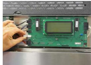
Desconecte o condutor de energia de 24 volt no Painel de Controle Principal.
