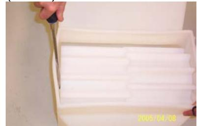
Quando retire o Rotor, use uma chave de fenda comprida ou uma alavanca plana para levantar as laterais do Depósito o suficiente para liberar os eixos do rotor.
