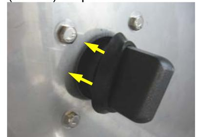
Monte o novo bloqueio usando os quatro parafusos fornecidos. Pressione a vedação sobre o eixo e aperte contra a parede do freezer.
