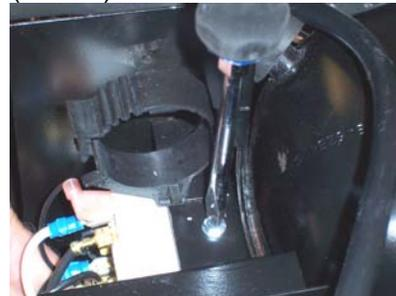
*Use uma chave de fenda Phillips para retirar os dois parafusos de montagem que unem o relé com o compartimento elétrico.*
