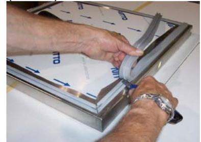
Para acelerar a substituição, corte a vedação velha da porta do seu anexo.
