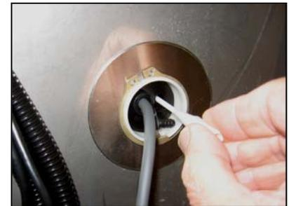
Após a remoção do pequeno plugue de plástico, use a chave de fenda de plástico de 1/16" (2 mm) para ajustar a sensibilidade.
