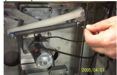
Use uma chave de fenda hexagonal de 1/8" para retirar e depois ajustar o parafuso de retenção da mola do lado direito.
