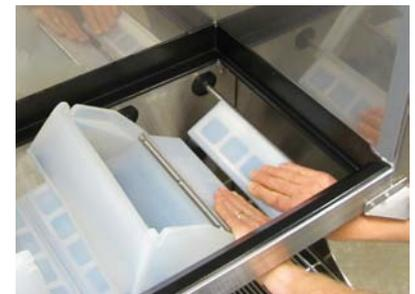
Teste a nova mola abrindo manualmente as portas de produto contra a tensão da mola. As duas portas devem girar para baixo contra a resistência da mola de extensão.
