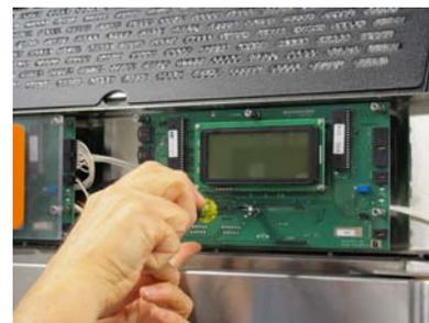
Use uma chave de porca de 1/4" (6 mm) para retirar os seis parafusos de montagem.
