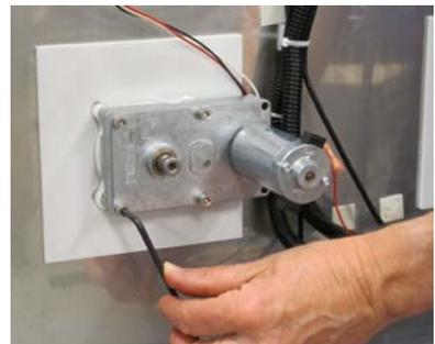
Retire os quatro parafusos de montagem do motor.
