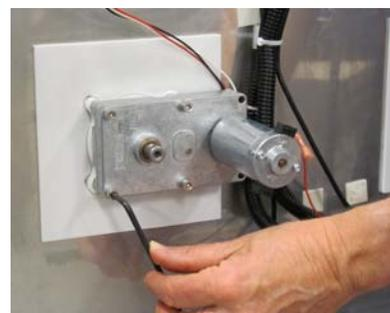
*Retire os quatro parafusos de montagem do motor.*
