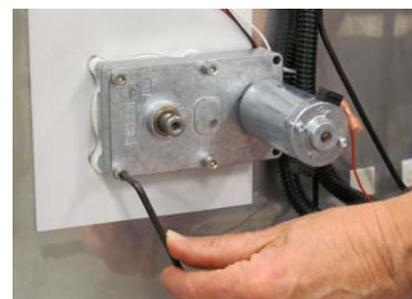
Solte os quatro parafusos de montagem do motor, ajuste e aperte para melhorar o alinhamento com o eixo de direção do rotor.
