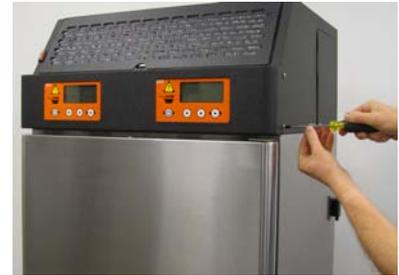
Retire os quatro parafusos do engaste/tampa do painel de controle frontal.
