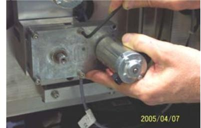
Retire os quatro parafusos de montagem do motor.
