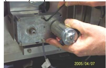
Retire os quatro parafusos de montagem do motor do Motor de Levantamento da Porta.
