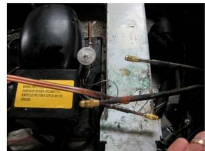
*Aperte e solde as linhas do lado alto ou use conexões de acesso dos lados alto e baixo (evaporador).*
