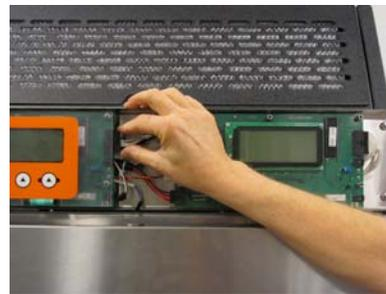
*Conecte o B-B (Auxiliar) ao terminal do painel de controle esquerdo.*
