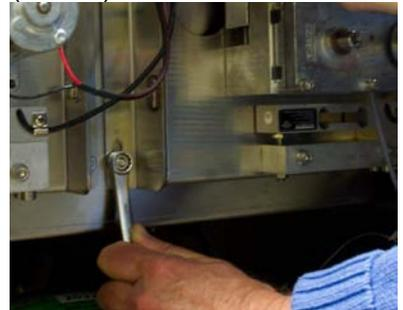
Solte os quatro canais "L" das porcas de montagem da moldura para ajustar a altura e a vedação do Conjunto de Levantamento da Porta.
