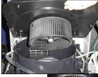
✓ Retire os 4 (quatro) parafusos Philips para acessar o motor.
