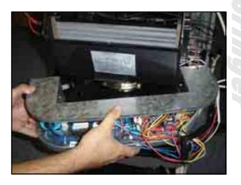
Retire os 4 (quatro) parafusos, dois de cada lado, que prendem o bocal do ventilador.
