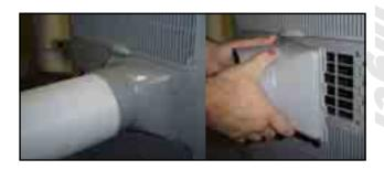
Desencaixe a mangueira de saída de drenagem proveniente da bomba de condensado.
