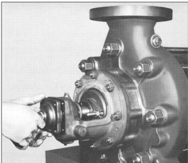
Fig. 58 - Montagem da tampa de mancal
