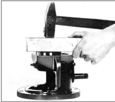
Fig. 50 - Montagem do rolamento (322) no corpo de mancal (350)
