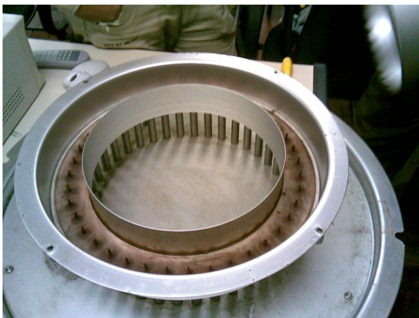
Figura 9.7 Anel Poroso na Canaleta do Meio Oleoso com Excesso de Depósitos
