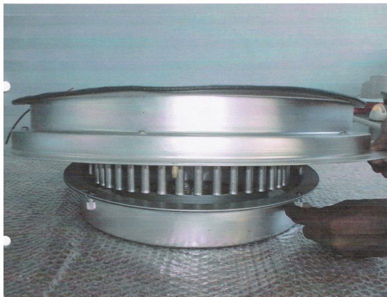
Figura 9.4 O Módulo MP 2,5 , mostrando as pontas das boqueiras de aceleração
