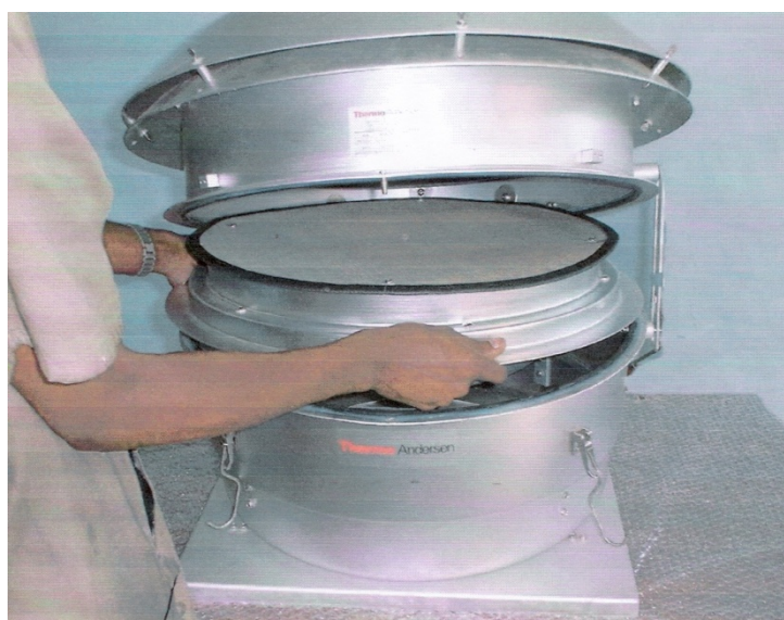
Figura 9.2 Abertura da Cabeça, mostrando o Módulo MP 2,5
