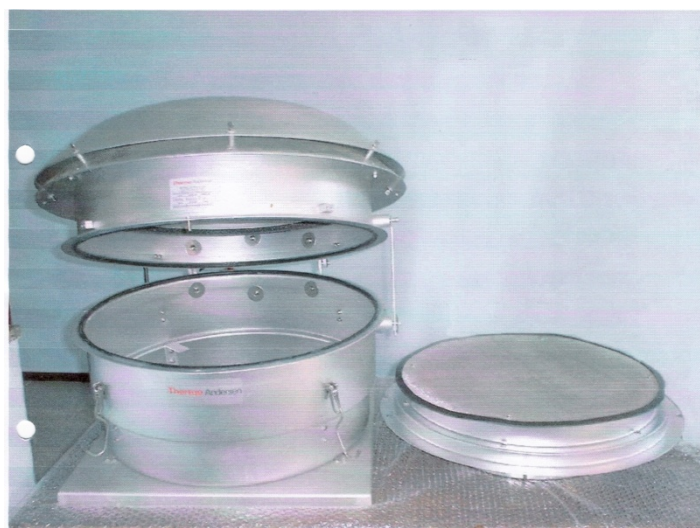
Figura 9.3 A Cabeça com o Módulo MP 2,5 removido
