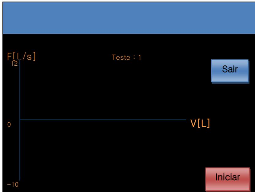
Depois de pressionar "Iniciar", e se o paciente estiver com o bocal na boca e começar a respirar, a máquina inicia a medição (lembre-se de seguir a sequência de respiração indicada para o teste). Se o módulo de espirometria não estiver conectado ou estiver desligado, aparecerá a seguinte mensagem.
