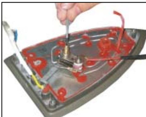
Para aumentar a temperatura prenda o eixo do termostato e com uma chave de fenda apropriada gire o parafuso de calibração no sentido anti-horário.
