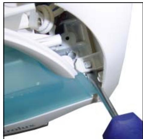
6 - Soltar os dois encaixes inferiores, localizados na parte interna da tampa traseira com uma chave de fenda.
