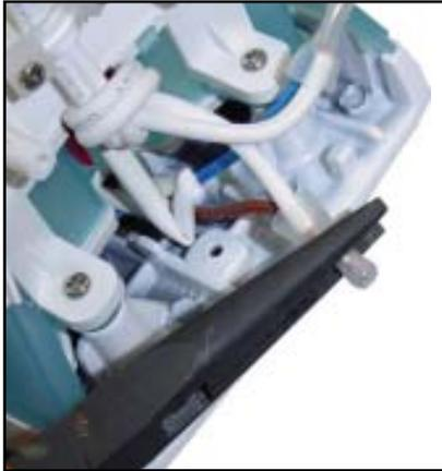
12 - Com um alicate de bico desconectar as ligações elétricas para soltar o cabo elétrico.
