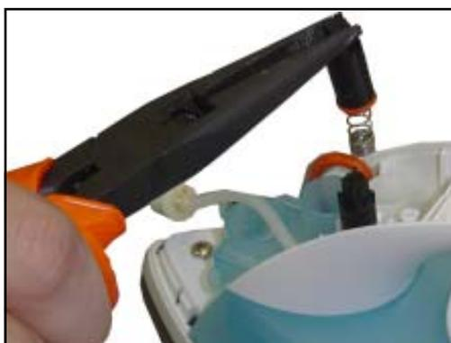
10 - Puxar com auxílio de um alicate de bico a bomba de spray e a bomba de vapor.
