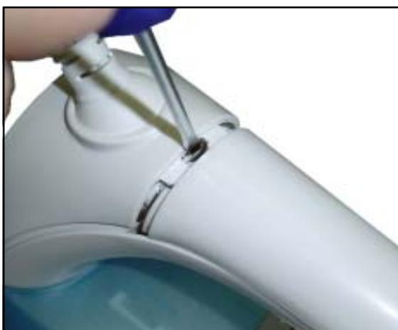
5 - Com uma chave de fenda, desencaixar a parte superior da tampa traseira.
