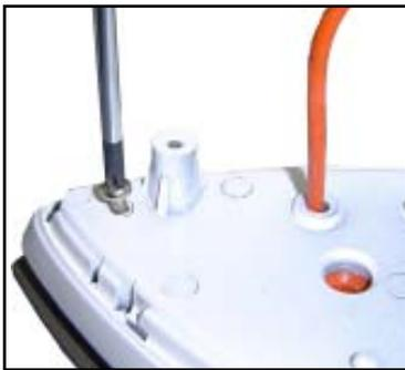
1 - Retirar os 3 parafusos que fixam a cobertura interna da base.
