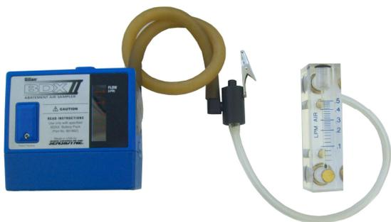
Bomba de amostragem + Redutor de vazão + rotâmetro até 500 ml/min.
