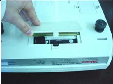
**1)** Com a balança desligada e sem bandeja, vire-a de pés para cima e retire a tampa da bateria.
