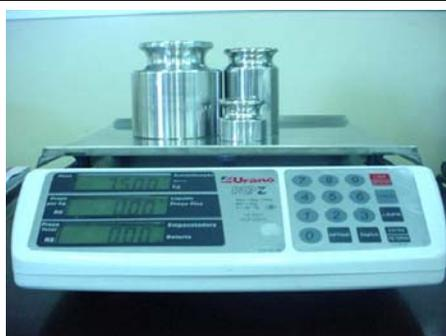
1) Coloque a carga inicial referente ao modelo sobre a bandeja e espere estabilizar.
