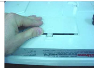
**6)** Recoloque a tampa da bateria, desvire a balança e recoloque a bandeja.
