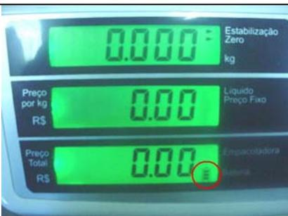
**7)** Desligar o equipamento da rede elétrica e ligar a balança somente com a bateria.
