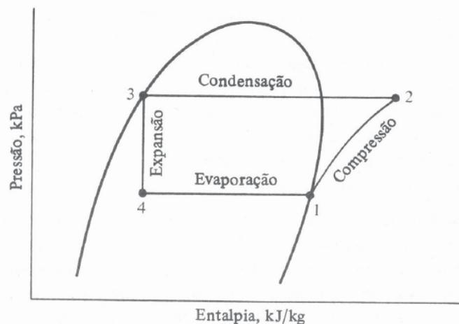
Figura 5 – Diagrama Pressão x Entalpia do Ciclo ideal de refrigeração por compressão de vapor (Stoecker, 1985)
