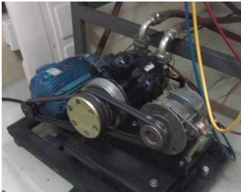
Figura 6 – Compressor acoplado com o motor
