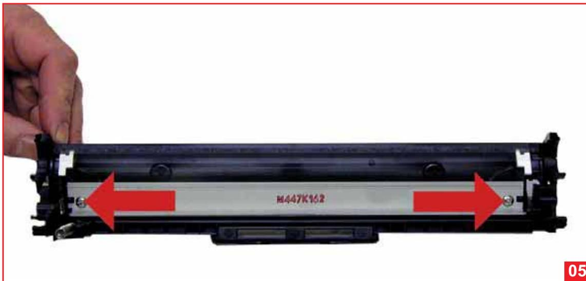
5. Tirar os parafusos que sustentam a lâmina de limpeza e desmontá-la.
