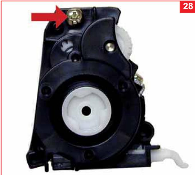
28. Colocar a tampa com sua engrenagem montada, certificando-se de que o braço branco funcione corretamente e parafuse a tampa firmemente em seu lugar
