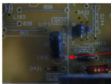
Modo como foi montado o capacitor C435.
