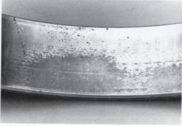
"Descamação" da pista de rolamento
