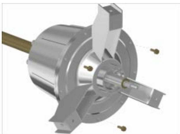
25. Com uma chave canhão 7/16", coloque de forma equidistante três dos nove parafusos que fixam a base à caixa da transmissão.
