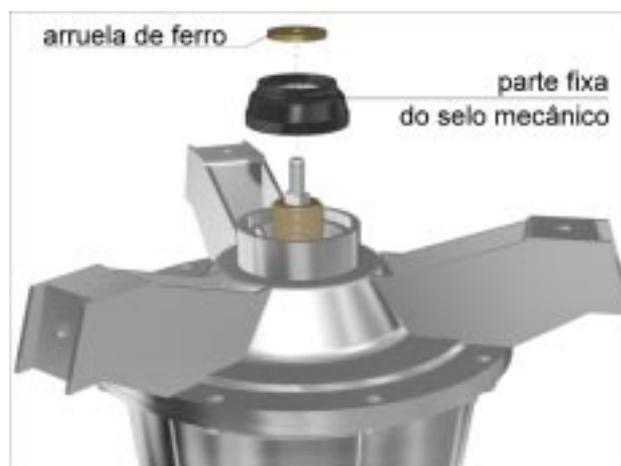
6. Com uma chave fixa de 9/16", trave a extremidade superior do eixo agitador.
