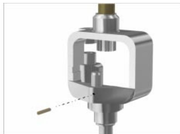
23. Na prensa, utilizando os gabaritos descritos nas páginas 46 e 47 remova o eixo da engrenagem manivela.
