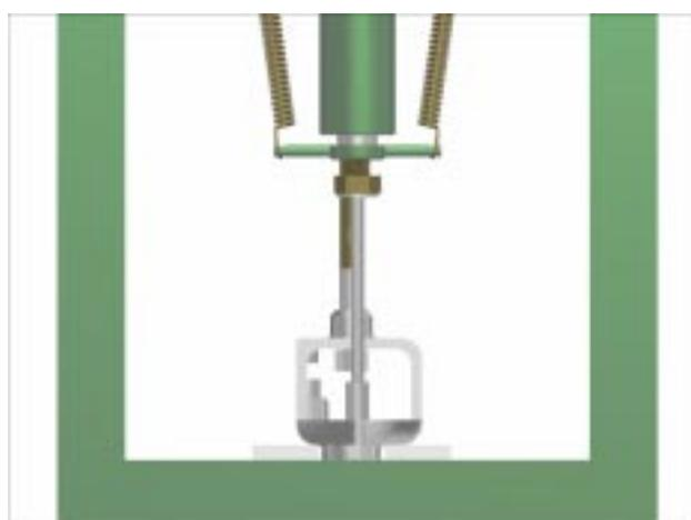
12. Na prensa, utilizando os gabaritos descritos nas páginas 49 e 63, coloque o eixo da engrenagem manivela.
