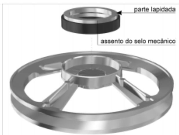
5. Remova a arruela de aço do colar da mola e, em seguida, a parte fixa do retentor selo mecânico de óleo.
