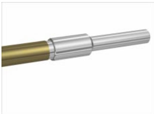
11. Utilizando o dispositivo descrito na página 44, coloque o retentor entre o tubo e eixo.
