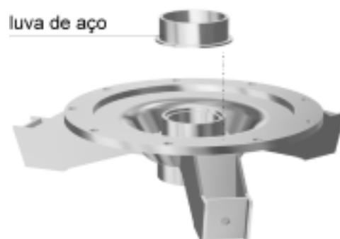
9. Utilizando um saca pino, desloque o pino elástico de trava da luva de aço, removendo-o.
