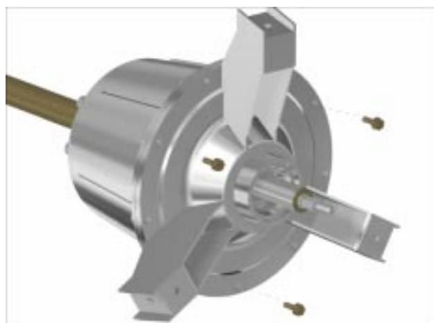
29. Novamente na mesa especial, remova os três parafusos retirando a base da transmissão.
