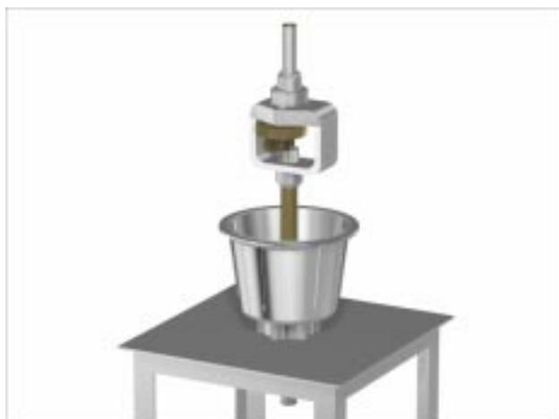
23. Coloque a carcaça de engrenagens montada na caixa da transmissão e, em seguida, coloque o conjunto na mesa especial.
