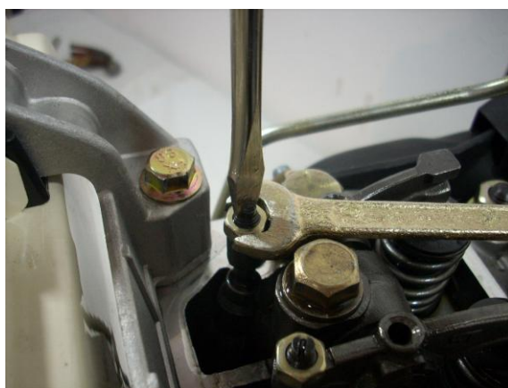
6 - Girar o parafuso para ajustar a folga. Assim que a folga estiver ajustada, apertar contra porca do parafuso de regulagem.
