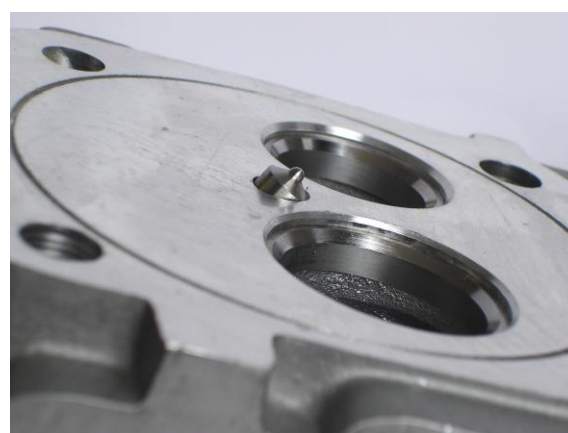
6 - Com o auxílio de um paquímetro, medir o quanto o bico está passando da base do cabeçote. Feita a medição comparar com os valores abaixo:
