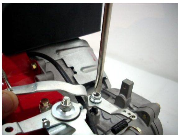
6 - Girar o eixo do R.A.R. no sentido horário até que ele pare, ou seja, esteja totalmente fechado. Nos motores de 8.0 e 13.0 girar no sentido ANTI-HORÁRIO.
