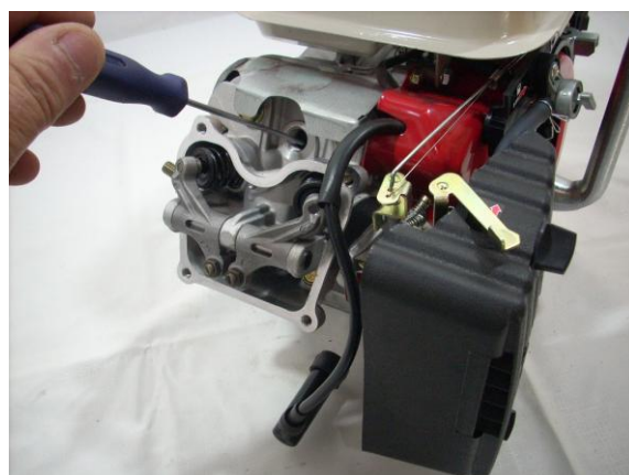
5 - Com o auxílio de uma chave de fenda longa e fina, posicionar o pistão no PMS no ciclo da compressão. Neste ponto as válvulas estarão totalmente fechadas
