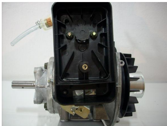
7 - Retirar as porcas e o parafuso de fixação do corpo do filtro de ar e retirá-lo.
