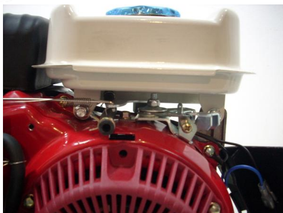
4 - Soltar os parafusos e retirar o tanque.
