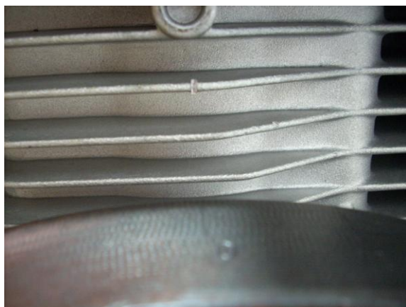
3 - Colocar o "0" da escala do volante alinhado com a marca do bloco.
