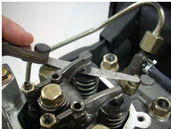
4 - Verificar a folga das válvulas inserindo uma lâmina de calibre entre a válvula e o balancim. A folga das válvulas de admissão é exaustão é de 0,15 mm
