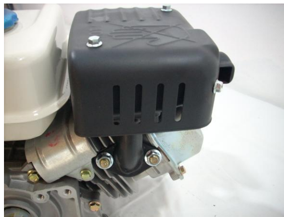
1 - Soltar porcas de fixação do escape e retirá-lo.
