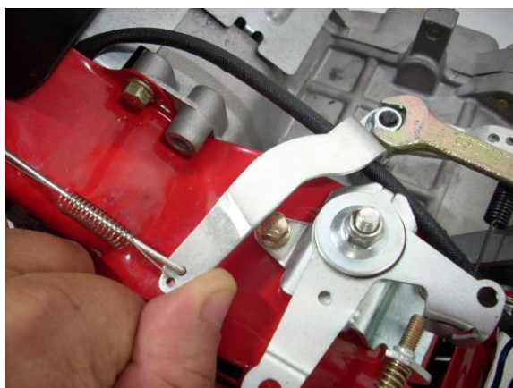
5 - Empurrar a haste do R.A.R. no sentido de aceleração total do motor e mantê-la assim durante todo o processo de regulagem. Soltar a porca de fixação da haste.
