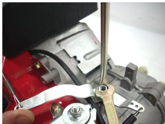
7 - Mantendo a haste acionada, apertar a porca de fixação.
