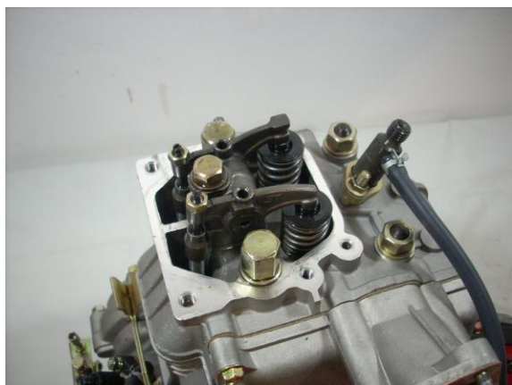
5 - Soltar os parafusos do cabeçote e retirá-lo.
