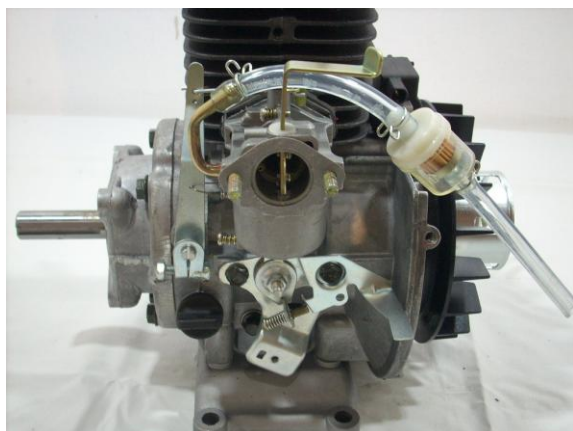
8 - Soltar a mola compensadora do tirante de ligação do carburador e retirá-lo.
