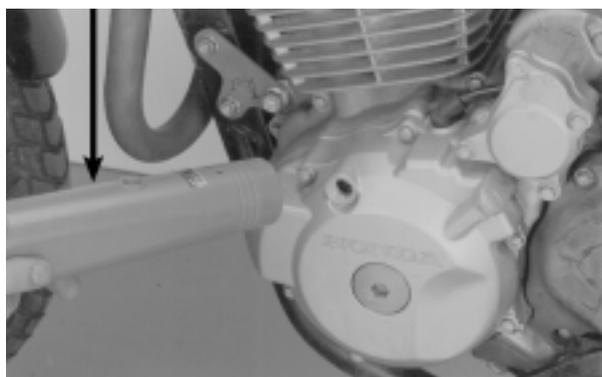
O ponto de ignição estará correto se a marca "F" estiver alinhada com o entalhe de referência da tampa lateral esquerda da carcaça do motor em marcha lenta.
