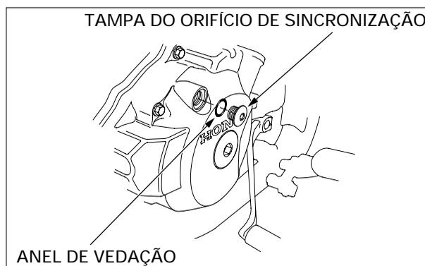
Conecte a lâmpada estroboscópica no cabo da vela de ignição.
