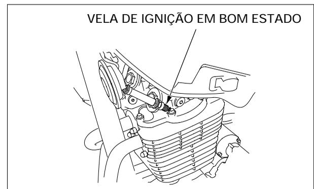
Acople o adaptador de pico de voltagem ou as pontas de prova do testador Imrie no fio da bobina de ignição.
