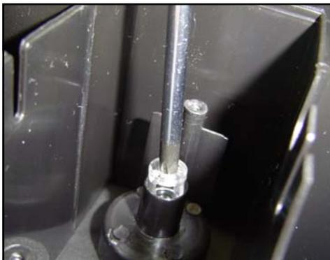
5 - Introduzir a chave philips no orifício da válvula e puxar a mesma para cima, *observar a posição da esfera no interior da válvula.*
