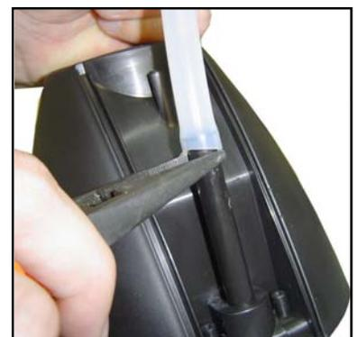
10 - Soltar e retirar os parafusos que fixam o corpo ao suporte do filtro tendo assim acesso a mangueira. Soltar a mangueira, apoiando o alicate e empurrando para cima, não puxar a mangueira com o alicate, pois esta pode romper-se.
