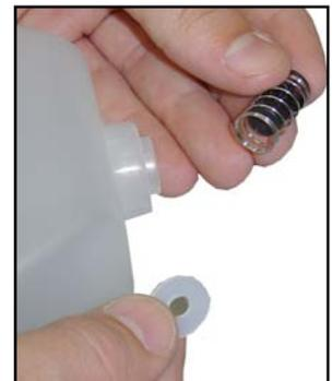
1 - Para trocar a válvula do tanque d'água, remover a tampa do tanque, empurrar a válvula para dentro do tanque, dessa forma soltará a mola e a válvula, proceder a troca.
