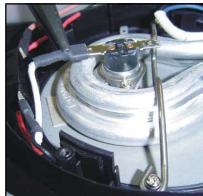
7 - Soltar os dois parafusos que fixam o fusível térmico e retirar.
