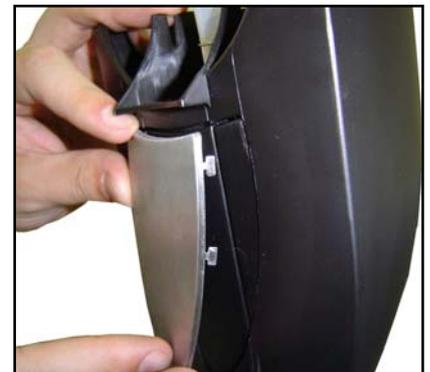
6 - Desdobrar as travas metálicas que fixam o arremate metálico frontal, desencaixar o arremate frontal do corpo e retirá-lo.
