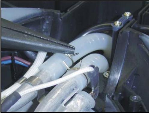
4 - Com o alicate de bico, soltar o grampo que fixa a mangueira de água.
