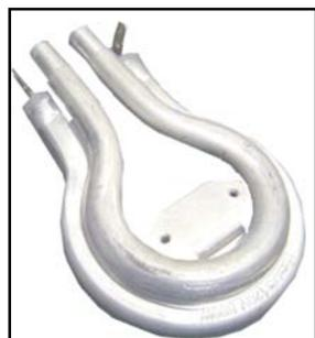
Testar com o multímetro a resistência ôhmica do componente: **127V +/- 19Ω**
