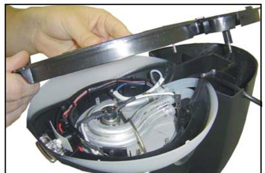
3 - Retirar os pézinhos localizados na tampa da base da cafeteira. Com a chave philips, soltar e retirar os seis parafusos. Desencaixar e retirar a tampa da base.
