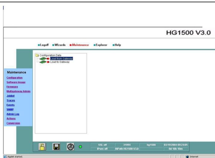
3. Use o "Maintenance/Configuration/Load from Gateway" para salvar os dados da nova configuração do HXGS3, HXGR3 ou HXGM3 para o "C:\conversion\hg1500.xml". De fato use o mesmo nome de arquivo base como no passo 2 e adicionando a extensão "xml".
