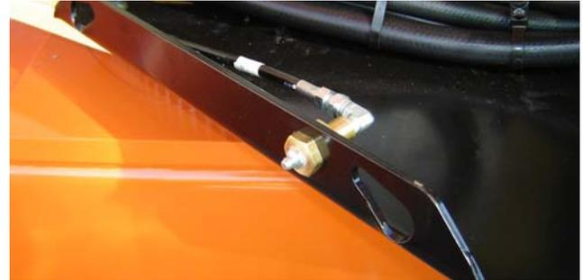
Ponto(s) de lubrificação - 1 Lubrificado
