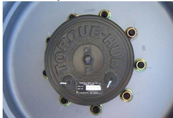
Ponto(s) de lubrificação - Nível/Bujão de enchimento
