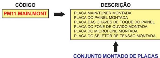
Portanto, caso haja necessidade da troca da placa do microfone, por exemplo, será utilizado o código **PM11-MAIN-MONT** para solicitação da placa, que será enviada com todas as placas do **CONJUNTO MONTADO DE PLACAS**.
