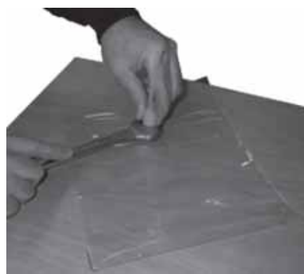
Fig. 52 Substituição do saco de compensação de volume
