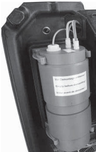
Fig. 45 Tanque de reacção e tanque batch de OCD-162-5, -10
