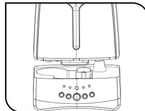
2. Rosqueie a tampa, certifique-se que não há vazamento pela vedação da rosca, encaixe o reservatório de água sobre o gabinete, conecte o cabo do aparelho na tomada. Ligue o aparelho pressionando o botão “Liga / Desliga”, localizado no painel frontal;
