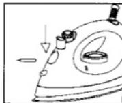
**Seco / A vapor** - *Você pode ajustar a intensidade do vapor diretamente, girando o botão de controle (3):*
