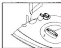
Desligue o ferro da tomada e gire o controlador de temperatura (6) para a posição “0” (desligado).
