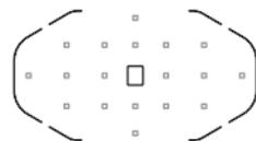
Com AI Servo AF, o ponto AF manualmente seleccionado (p.88) <□> é utilizado em primeiro lugar para se obter a focagem. Isto não pode ser definido nos modos totalmente automáticos (□/CA).
