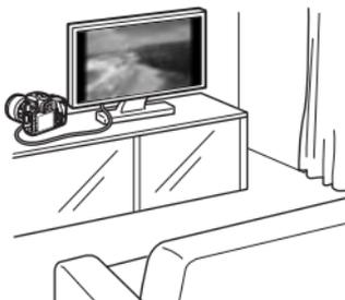
Utilize o cabo AV fornecido ou um cabo HDMI HTC-100 (vendido em separado) para ligar a câmara a um televisor.
