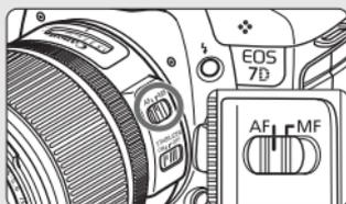
**Coloque o interruptor de modo da focagem da objectiva na posição <AF>.** (p.31)
