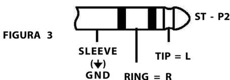
Esta figura demonstra como está ligado o conector para plugue stereo P2 (1/8" TRS), sendo que: através do TIP é conectado o lado L (esquerdo) desses audio-equipamentos stereo; através do RING é conectado o lado R (direito); através do GND é feito o aterramento do cabo de conexão desses audio-equipamentos.
