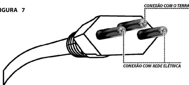
1 - Alimentar o audio mixer MXS 12 SD / MXS 10 SD / MXS 8 SD / MXS 6 SD com a tensão da rede (90V a 260V), através dos dois pinos das extremidades de sua tomada.
