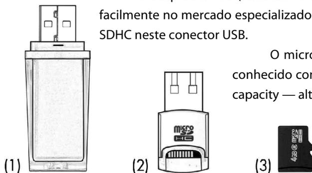
A figura a seguir, mostra como inserir o mini cartão SD ou SDHC corretamente no adaptador USB. Para realizar essa operação com segurança, basta seguir a sequência das figuras abaixo. Fique atento e identifique corretamente o lado certo tanto do cartão quanto do adaptador na hora da inserção.
