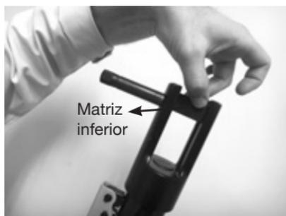
4. Após montar o terminal no cabo, posicione o mesmo entre a matriz inferior já posicionada conforme passo 3. Após esse procedimento, posicione a matriz superior e coloque o batente de volta ao seu local de origem.
