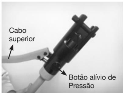
6. Finalizada a crimpagem, gire o botão alívio de pressão novamente para a posição off a fim de liberar a pressão interna. O pistão irá retrair liberando assim as mandíbulas do cabo crimpado. Remova o cabo e inicie novamente o processo a partir do item 4, caso mais terminais do mesmo diâmetro necessitam ser crimpados. Caso o próximo terminal a ser crimpado é de outro tamanho, repita os passos desde o item 1.
