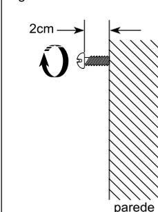
Instale seu aquecedor na parede seguindo os passos a seguir:
