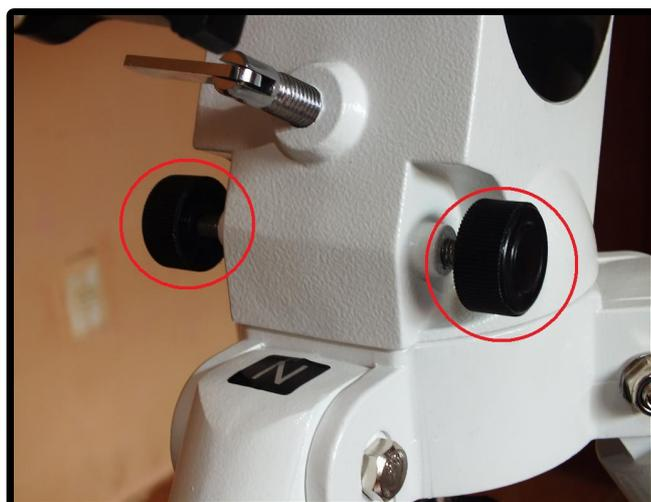
Atenção: Parafuse bem essas presilhas. Após montado, enrosque novamente os rolamentos do “ Ajuste de Azimute ”, deixando-os bem fixos.
