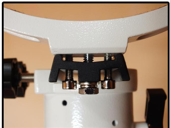
Observação : Os parafusos de ajuste do dovetail e os parafusos de apertam o anel, devem estar virado para o lado da “ escala de latitude ” . Mostrado na foto abaixo.
