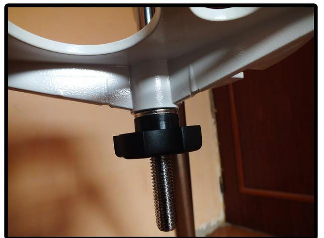
Segure com uma mão e com a outra, coloca as peças que irão prender a bandeja dos acessórios na parte de baixo. E vá enroscando até ela ficar fixa. ( *Veja acima* ).
