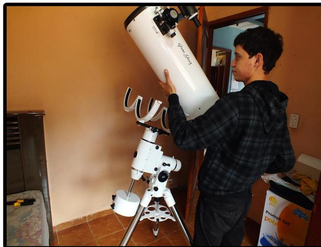
Coloque o tubo óptico e permaneça segurando ele com a outra mão.
