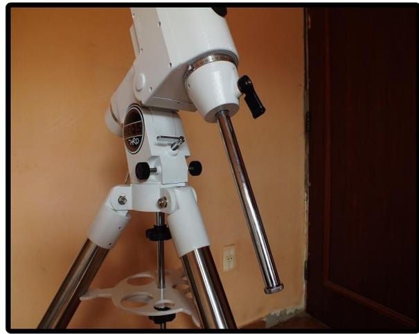
A haste do contrapeso. Como vemos na foto, há uma manivela no eixo de declinação, vamos destravar essa manivela, e o haste que é embutido, deslizará para baixo.
