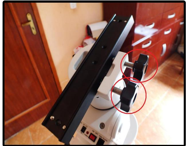
Com as manivelas ( *no detalhe em vermelho na segunda foto* ), você terá que rodar até que ela pressione o dovetail. Aperte bem, não deixe frouxe, ou correrá o risco do dovetail escorregar quando estiver com o telescópio em cima.
