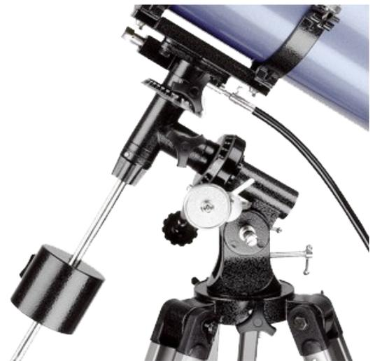
**EQ 3:** *A pesada montagem EQ3 apresenta controles de 360° e engrenagem sem-fim de rastreamento em ambos os eixos, cabo flexível de ajuste AR e DEC e botões de trava dos eixos, duplos círculo de ajuste, um parafuso de ajuste de latitude, e uma suporte âmbito polar. Ele pode ser equipado com um motor de eixo simples, para o rastreamento automático.*
