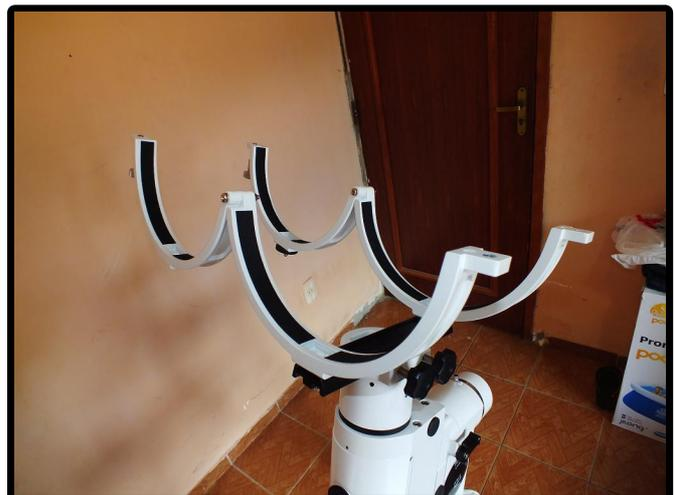
Após os anéis estarem abertos, iremos colocar o tubo óptico dentro dos anéis, com muito cuidado.
