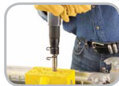
Instalação de rebitador pneumático
