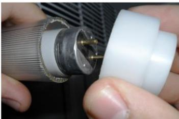
4 - Efetue a substituição da lâmpada, encaixe a tampa do conjunto, encaixe o conjunto nas presilhas e no soquete e gire o conjunto até travar;
