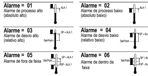
**OBS. 1.** Os tipos de alarme 11, 12, 13, 14, 15 e 16 são idênticos respectivamente aos tipos 01, 02, 03, 04, 05 e 06 porém com a função inibição: a saída permanecerá desligada até a temperatura ter atingido uma vez o set-point, após isto a saída dependerá das condições de alarme.
