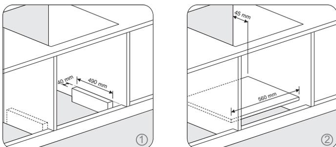
O forno poderá ser apoiado sobre dois suportes de madeira fixados nas laterais do nicho (1), deixando a base aberta, facilitando a ventilação. Outra forma de embutimento é a base de apoio plana (2), neste caso é necessário um recorte para saída de ar de 45 x 560 mm na parte traseira da base.
