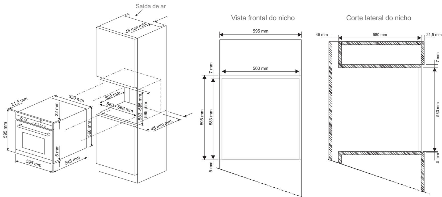
O desenho abaixo informa todas as medidas necessárias para a instalação do produto embutindo o forno sob fogões.
