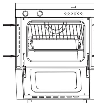
Para prender o forno ao nicho, após encaixado abrir a porta do forno e fixar os quatro parafusos nos quatro furos localizados em torno do quadro do forno.
