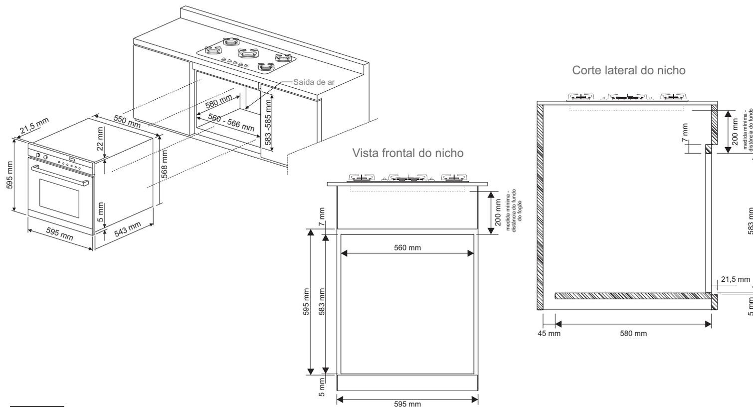
A base de apoio do forno elétrico Fischer Maximus embutir 56L no nicho de embutimento poderá ser feita de duas formas, conforme indicado nos desenhos abaixo.
